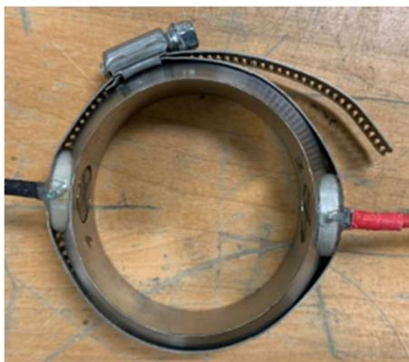
Figure 6.9: Anneaux piézoélectriques installés dans la paroi latérale de l'anneau œdométrique
