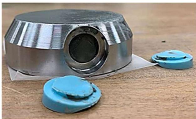
Figure 6.10: Anneau œdométrique et spécimen d'argile avant insertion des anneaux piézoélectriques
