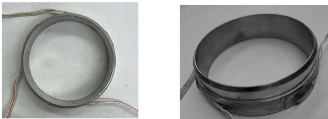
Figure 6.11: Anneau œdométrique équipé de jauges de déformation
