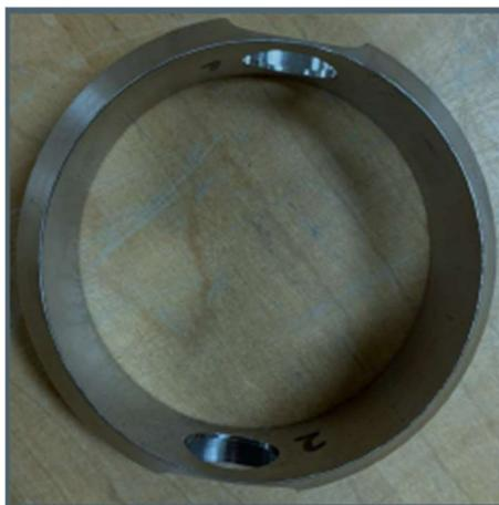
Figure 6.8: Anneau œdométrique découpée pour accueillir des anneaux piézoélectriques
