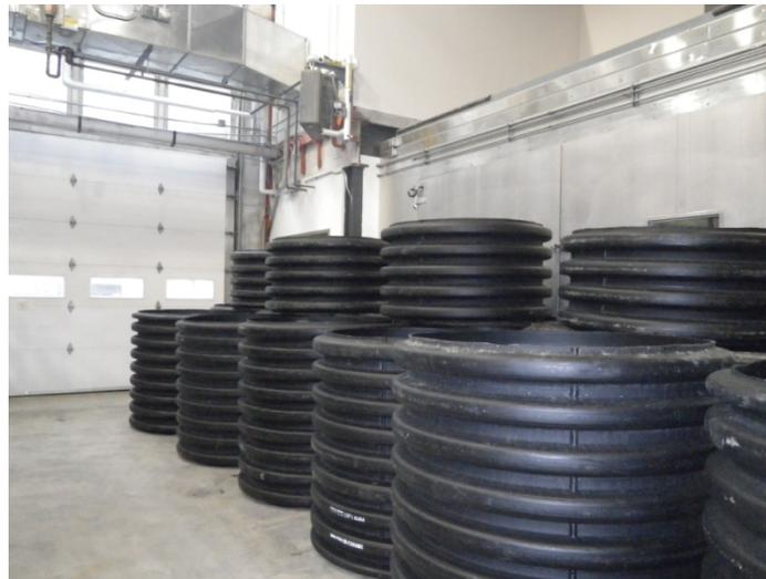
**Figure 20 : Tuyaux à paroi extérieure annelée (Solen).**
