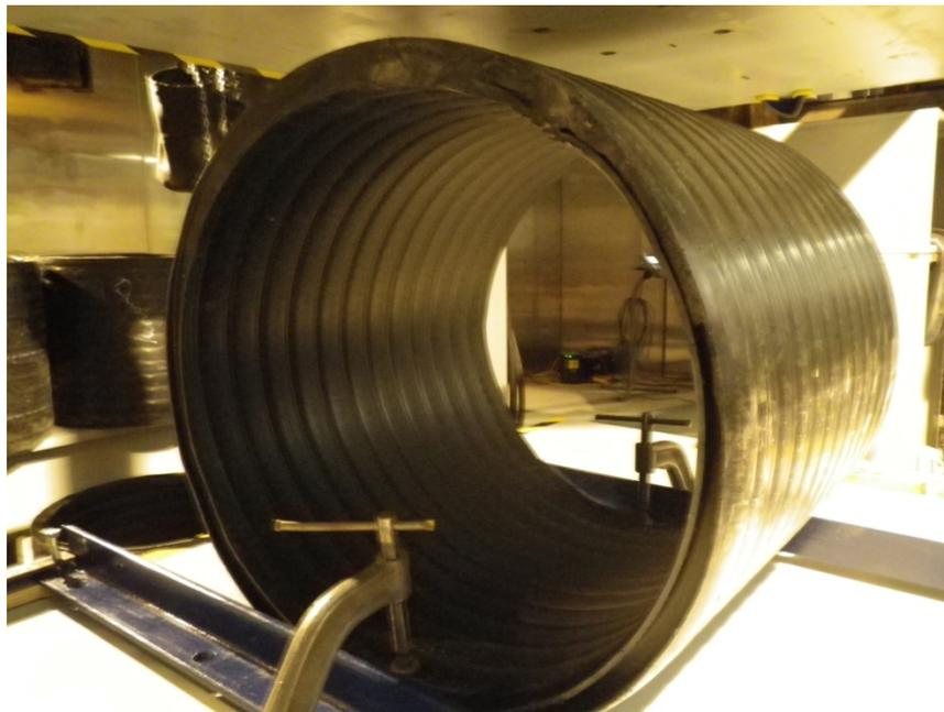
Figure 25 : Tuyau à paroi extérieure lisse ou à joints vissés (Weholite).
