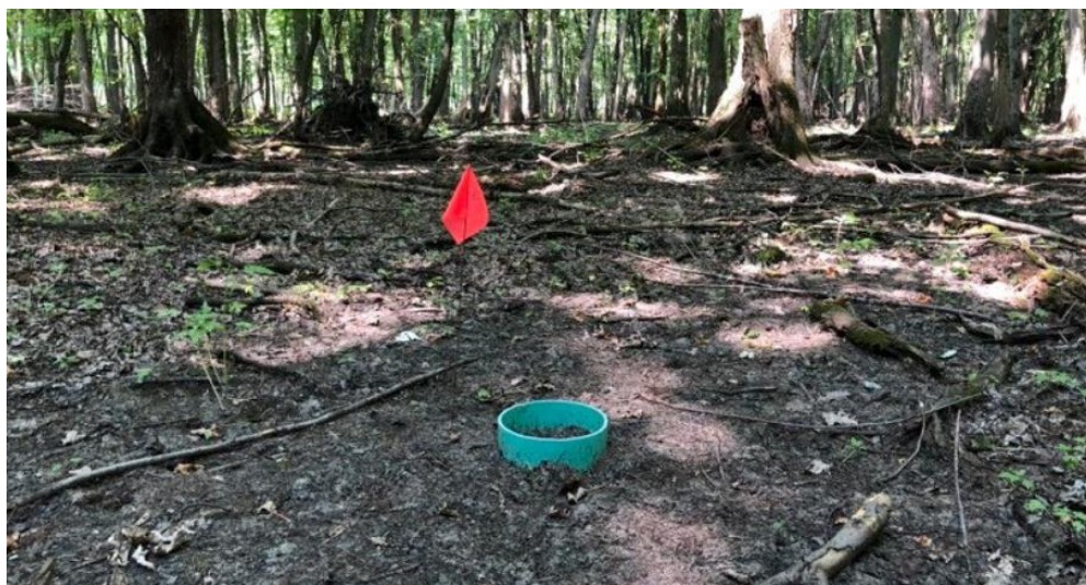
Figure 18. Collet pour mesurer les flux du carbone dans le sol en milieu forestier
