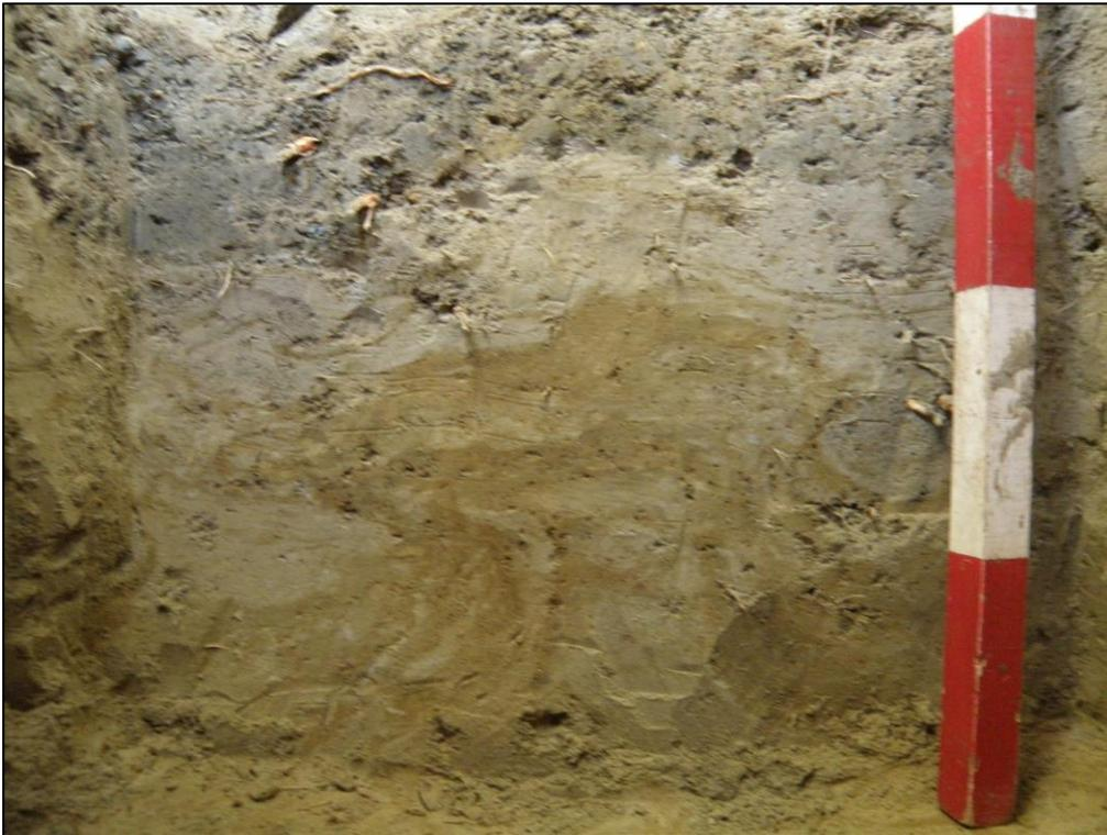
**Figure 40** : Sondage test #3, paroi nord, sous-zone 4, projet 154-14-0703 montrant de la cryoturbation (Photo : 154-14-0703\_070).
