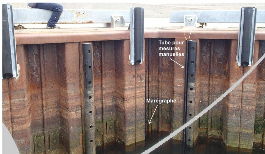
Figure 13 – Vue générale du marégraphe installé dans l'angle du quai et du tube temporaire utilisé pour les mesures manuelles.
