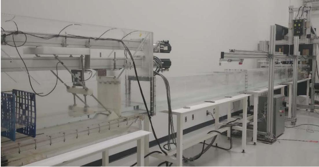
Figure 3.1 Petit canal à houle (INRS, LHE-CT, espace Hydées) : section 30x30cm<sup>2</sup>, longueur 12m : batteur piston et absorbeur (à gauche) ; sondes à vagues, vélocimétrie laser (à droite)
