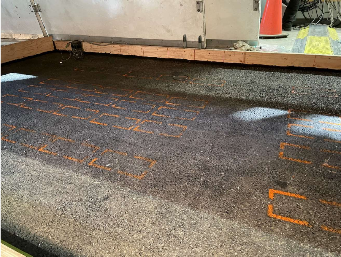
Figure 74. Marquage des points de mesures pour la sonde Capa et le percomètre afin d'estimer la teneur en eau
