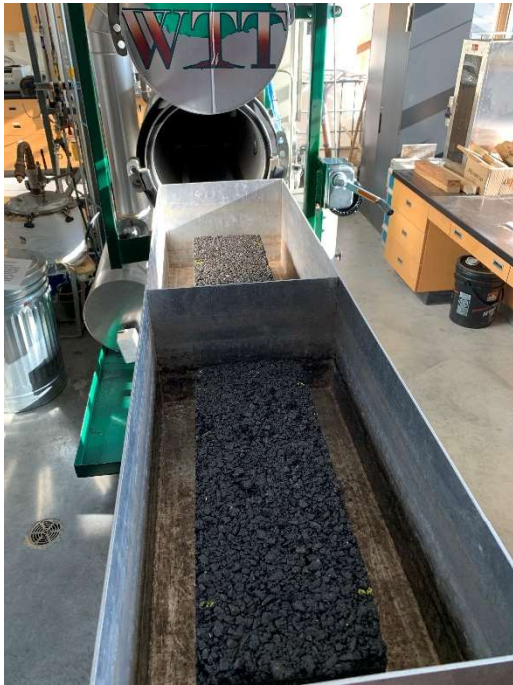
Figure 64. Chambre de pression/vide utilisée pour la saturation des plaques de ESG10
