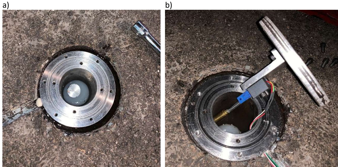
Figure 59. Déflectomètre de surface, a) Tête de mesure métallique collée, b) Potentiomètre fixé sur le couvercle
