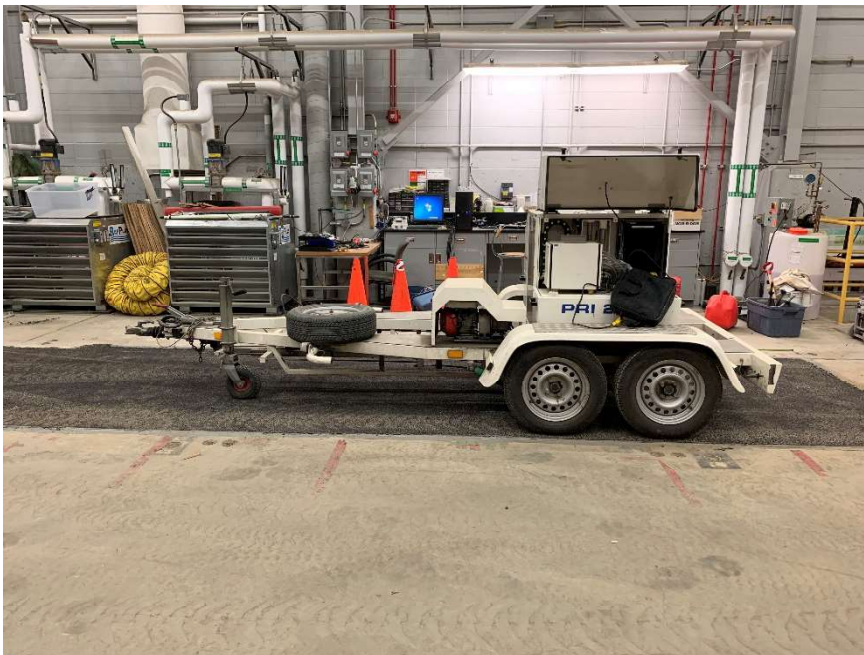
Figure 78. Appareil FWD positionné au-dessus de la fosse en X=1000 mm et Y=2000 mm
