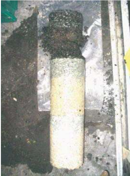
Figure 3. Carotte prélevée à proximité de désordres de type pelade ou nids de poule (Mauduit et al., 2013)
