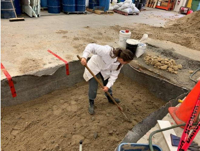
Figure 31. Mise à niveau des couches avec des pelles et un râteau
