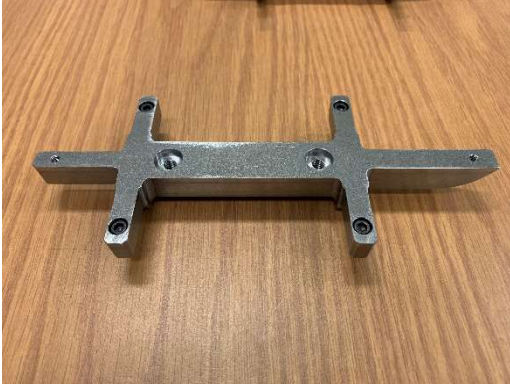
Figure 72. Moules de forme des jauges TML, a) vue de côté, b) vue de dessus
