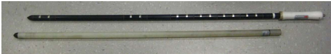
Figure 63. Capteurs de teneur en eau multiniveaux ProfileProbe (PrPr)
