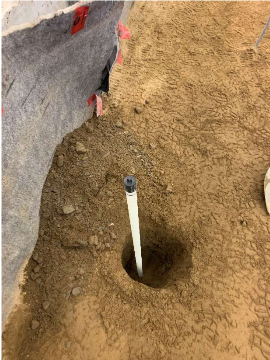
Figure 62. Tube d'insertion pour la sonde multiniveaux ProfileProbe
