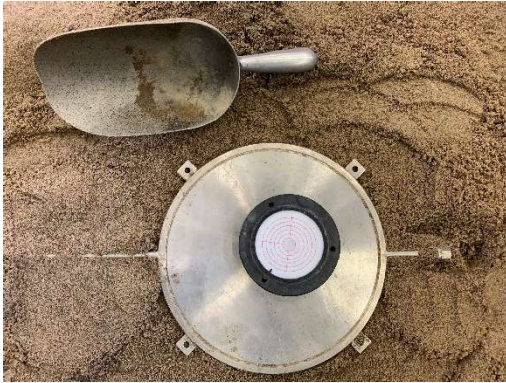
Figure 58. Mise à niveau des cellules de contrainte
