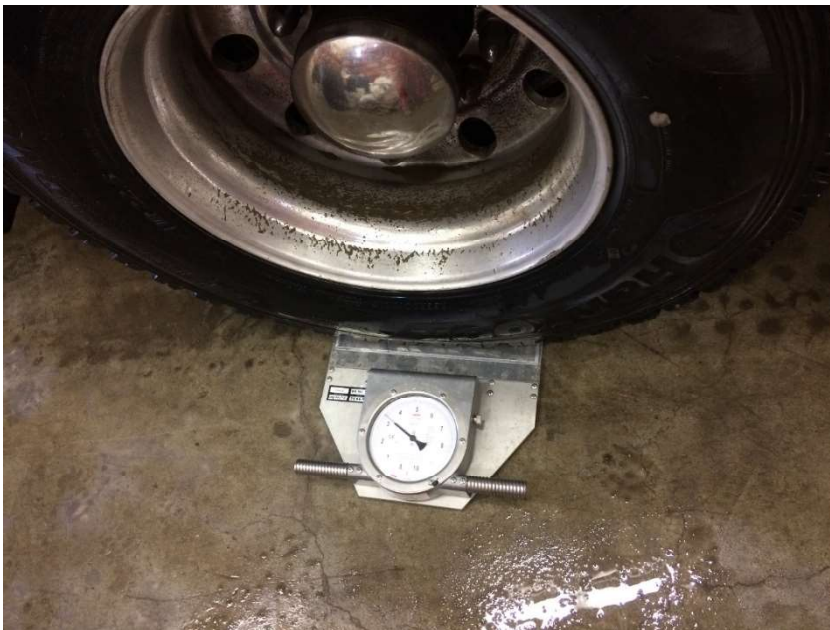
Figure 52. Pesée des essieux du camion
