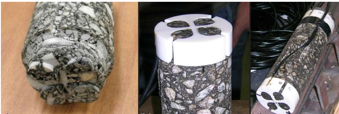
Figure 21. Montage et préparation d'une carotte d'enrobé bitumineux instrumentée avec des jauges à fibre optique (Grellet 2018)
