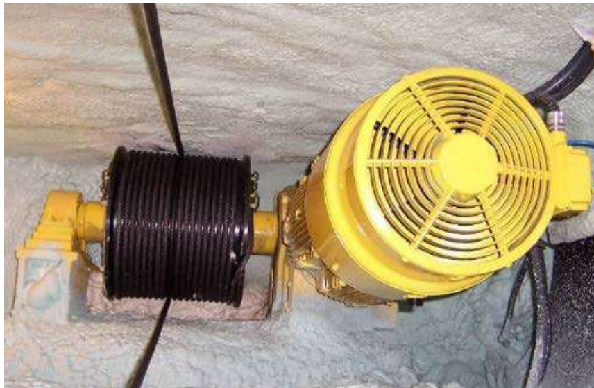
Figure 10. Poulie d'entraînement du chariot
