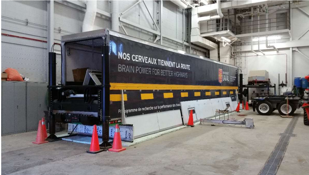
Figure 9. Simulateur climatique et de véhicules lourds de l'Université Laval en mode essai
