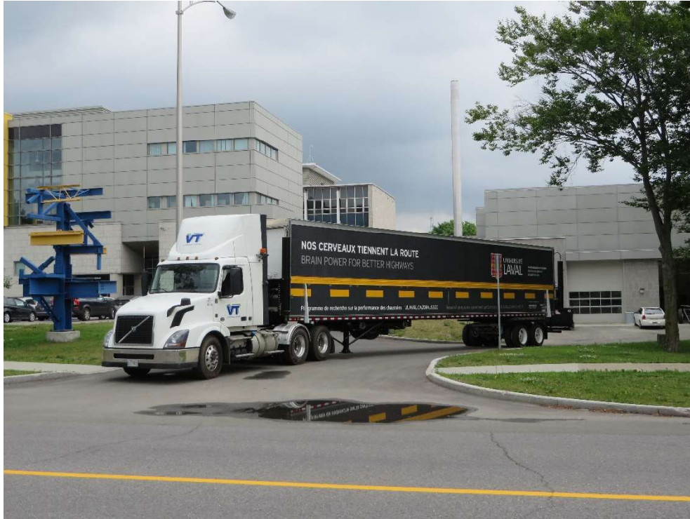
Figure 7. Simulateur climatique et de véhicules lourds de l'Université Laval tiré par une remorque
