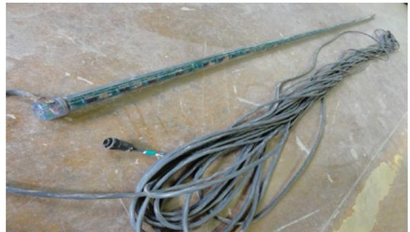
Figure 6 : Sonde électronique de profondeur de gel
