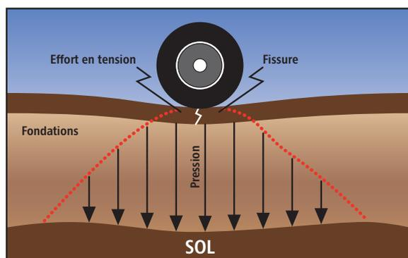
Figure 8 : Réaction de la chaussée sous la charge
