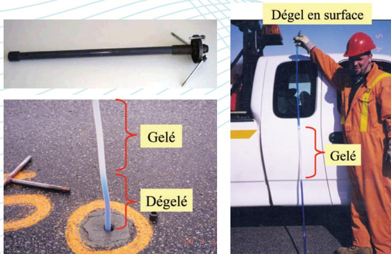
Figure 4 : Gelmètre - Lecture d'un gelmètre
