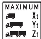
Le panneau « Limitation de poids » indique aux conducteurs de tous véhicules routiers dont le poids total en charge dépasse le poids maximal inscrit sur les panneaux qu'il leur est interdit d'emprunter un pont. Le «X» indique la masse totale en charge maximale d'un véhicule routier ou d'un ensemble de véhicules routiers.
