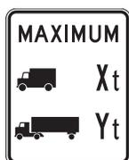
Les panneaux « Limitation de poids » indiquent aux conducteurs de camions\* dont le poids total en charge dépasse le poids maximal inscrit sur les panneaux qu'il leur est interdit d'emprunter un pont. Ces panneaux visent également l'autobus. Le «X» indique la masse totale en charge maximale d'un véhicule routier, le «Y» indique celle d'un ensemble de véhicules routiers de deux unités et le «Z» indique celle d'un ensemble de véhicules routiers de plus de deux unités.
