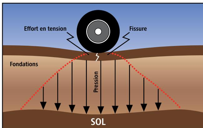
Figure 1 : Réaction de la chaussée sous la charge
