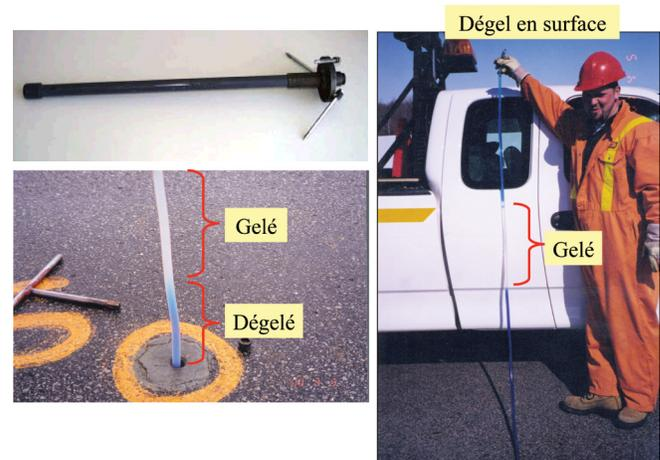
Figure 1 : Gelmètre – Lecture d'un gelmètre
