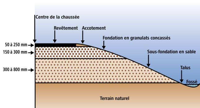
Figure 1 : Exemple de coupe type d'une chaussée
