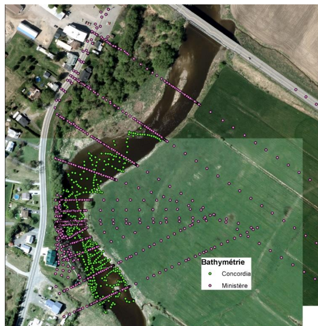
Figure 29. Mesures bathymétriques prises par l'équipe de l'U. Concordia au site de St-Albert (en vert), ajoutées à celles du Ministère des transports (en mauve).
