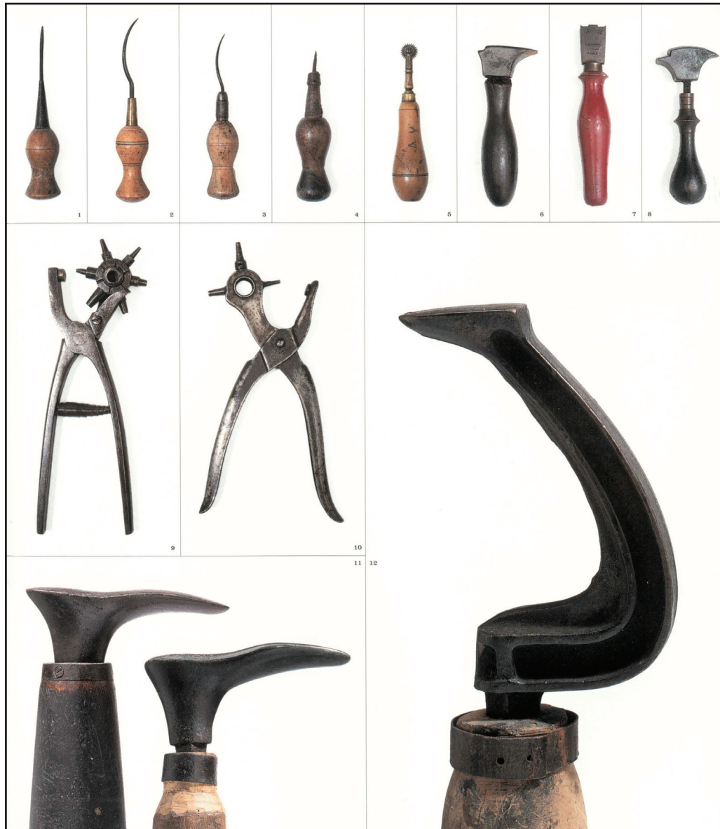
1, 2 et 3 - Alènes ; 4 - Broche à démonter ; 5 - Roulette à piquer ; 6 et 8 - Mailloches ; 7 - Fer à lisser ; 9 et 10 - Pinces emporte-pièce ; 11 - Pieds de fer : enclume de cordonnier ; 12 - Enclume à col de cygne
