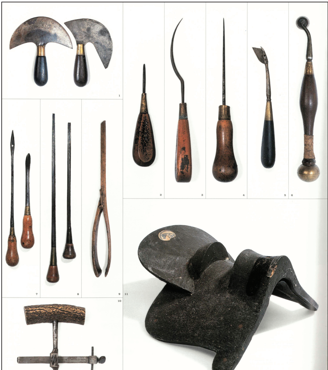
1 - Couteaux à pied pour découper le cuir ; 2, 3 et 4 - Alènes à brédier, alène à coudre : verges d'acier pour percer le cuir ; 5 - Couteau à surtailler ; 6 - Griffes avec molette crantée, pour tracer les piqûres sur le cuir ; 7 - Passe-corde ; 8 - Rembourroirs : ils servent à pousser la paille dans le collier ; 9 - Pince à coudre : elle est maintenue par une pression des jambes et permet, dans sa mâchoire, de serrer ensemble les pièces à coudre ; 10 - Compas à rondelles ; 11 - Armature en bois (arçonnerie française) sur laquelle la selle en cuir
