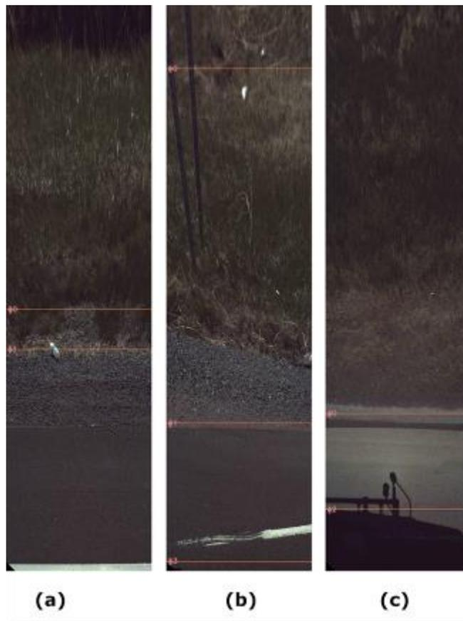
**Figure 26 Lignes non détectées à cause de leur position, inclinaison ou éclairage. (a) Ligne blanche collée à la bordure du bas de l'image (contre la voiture). (b) Ligne blanche trop inclinée. (c) Ligne blanche effacée et cachée dans l'ombre de la voiture (à peine visible à l'œil nu) <sup>45</sup>.**
