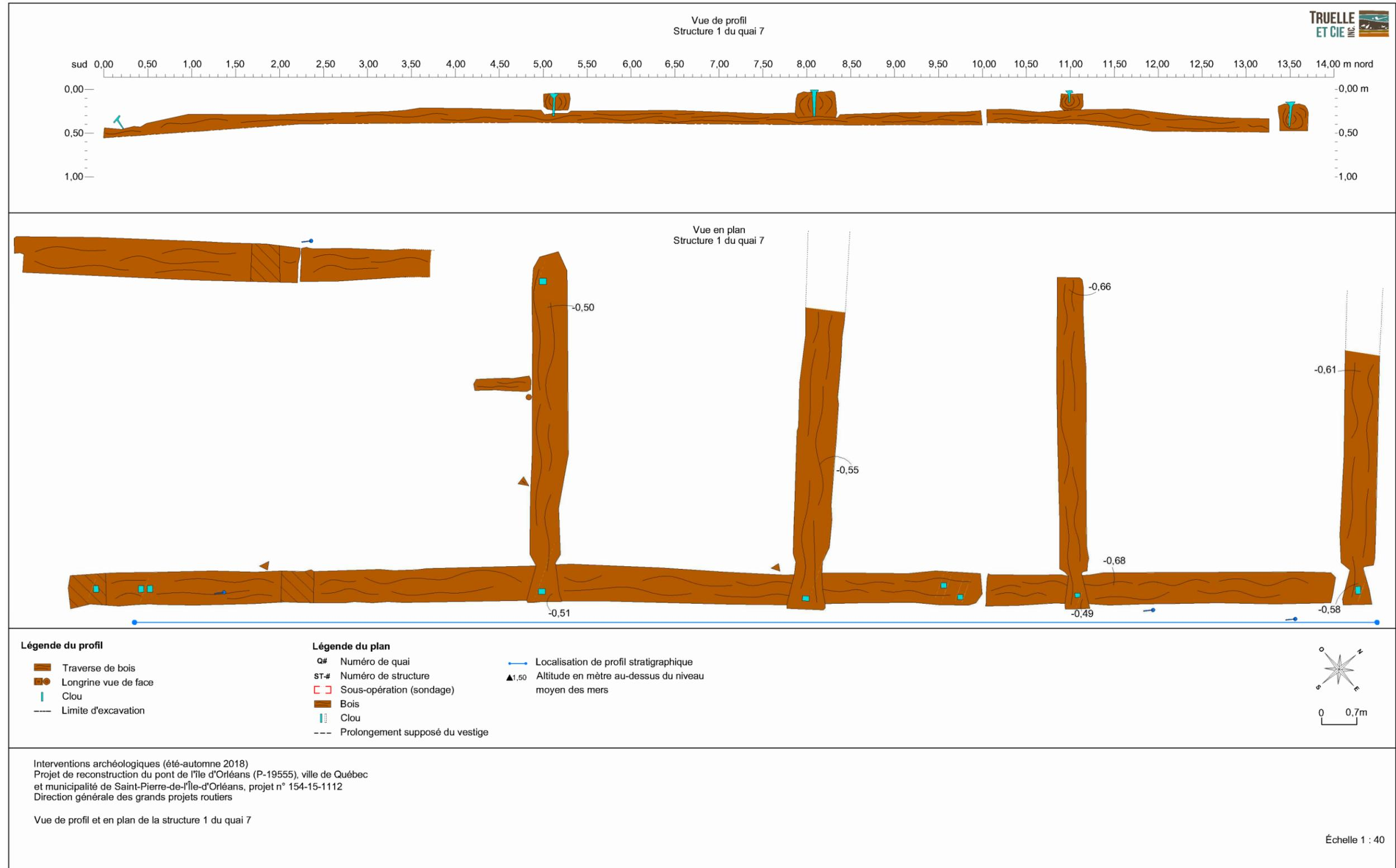
**Figure 69.** Vue de profil et en plan de la structure 1 du quai 7
