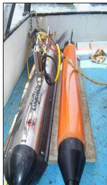
Figure 3 Sonar à balayage latéral (gauche, IRHMAS 2018-PIO-04-NUM1-101, Mercier Gingras 2019) et magnétomètre (droite, CIDCO 2019)
