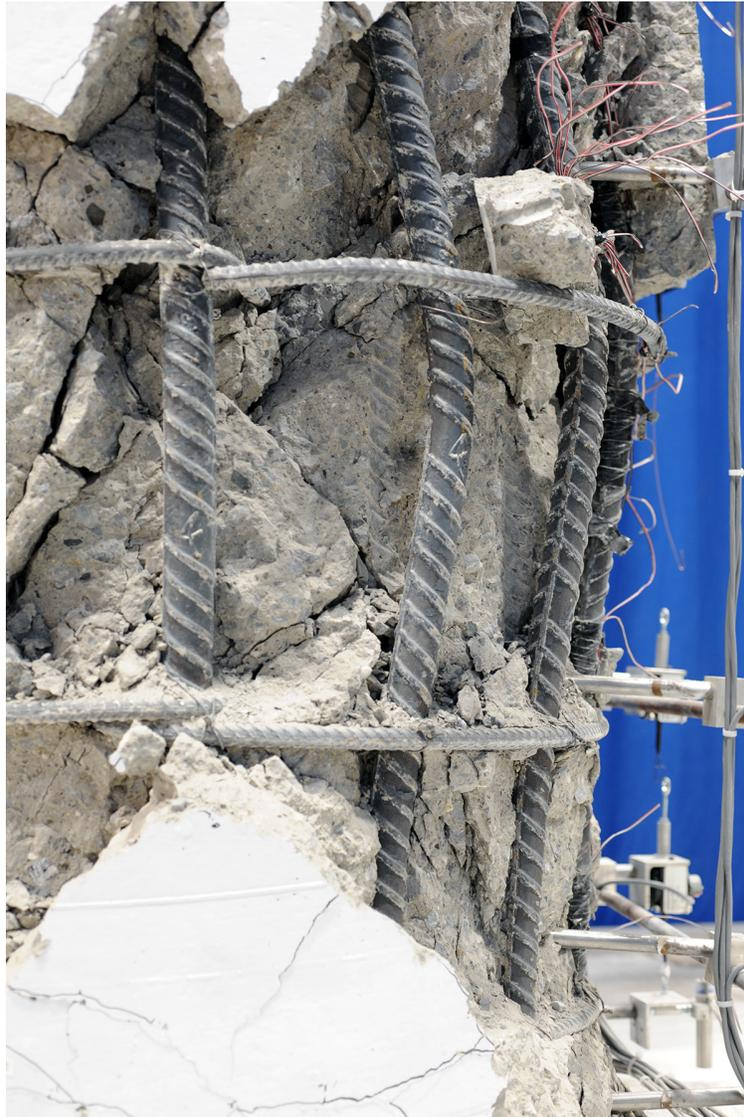
Figure 4.16 – Ouverture du crochet des cerces horizontales du spécimen CH300s
