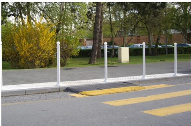
Exemple d'un aménagement provisoire de rampe d'accès au trottoir, en enrobé. Il est difficile d'évaluer si les exigences relatives aux pentes maximales sont respectées, mais ce type d'aménagement a le mérite de permettre de franchir la bordure. (Source : métropole de Lille)
