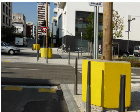
Les supports d'éclairage provisoire sont repérables, détectables et placés hors des cheminements. (Source Cerema)
