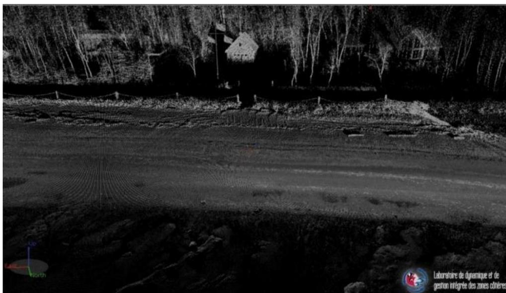
Figure 28. Exemple de modèle tridimensionnel LiDAR avant post-traitement réalisé sur le littoral de l'île aux Coudres (Chemin de la Bourroche) durant la campagne du 12 au 16 mai 2014. Source : Lambert et Bernatchez, 2014.
