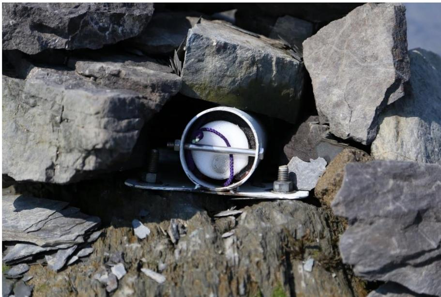
**Figure 124. Capteur fixé sub-horizontalement sur la plateforme rocheuse. La membrane est positionnée le plus proche possible du fond.**
