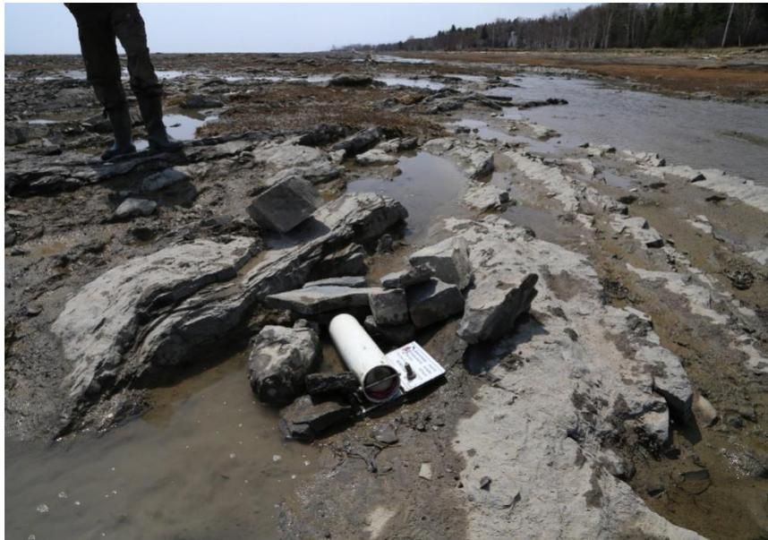
**Figure 126. Exemple de déploiement de capteur de pression sur la plateforme rocheuse réalisé lors de la campagne C1 (12 au 16 mai 2014)**
