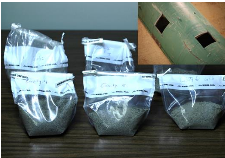
Figure 6.19. Les 6 prélèvements de sol effectués pour l'étude expérimentale d'une cavité localisée au voisinage d'un ponceau.
