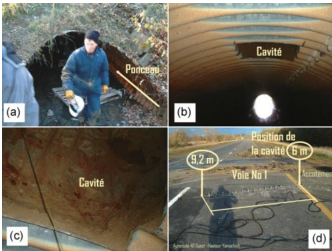
Figure 5.3. (a) Préparation pour la création d'une cavité (b) Découpage du ponceau en tôle ondulée (c) Intérieur de la cavité (d) Disposition des capteurs pour la réalisation des essais MMASW (Karray et Lefebvre, 2009a).
