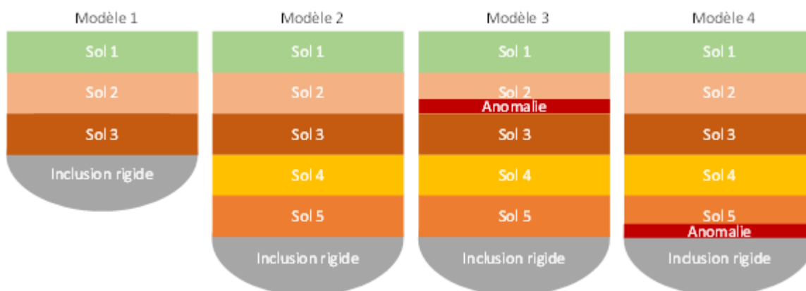
Figure 6.1. Illustration des 4 profils de sols considérés lors de l'analyse à l'aide de la méthode de la matrice de propagation. Les propriétés dynamiques des différents matériaux se trouvent dans la table 6.1.
