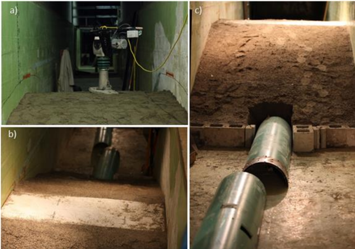
Figure 5.4. a) Mise en place et compactage du sol du talus; b) mise en place de la dalle de béton; c) Mise en place du demi-ponceau.
