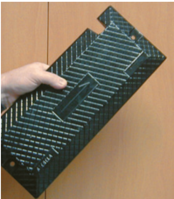
Compteur « plaque » : une plaque de détection
