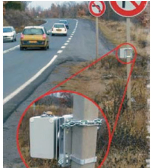
Compteur « radar » : ce type de radar ne prend qu'un seul sens de circulation derrière un panneau
