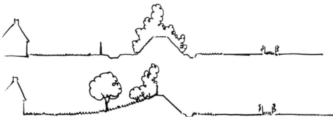
*Traitement classique d'une protection acoustique et possibilité de rétrocession à un riverain*
