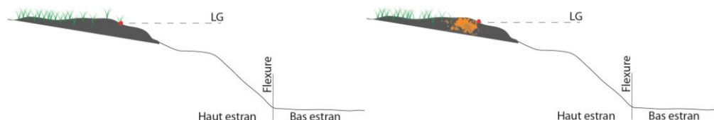
Figure 30. Localisation du critère éco-géomorphologique (point rouge) servant à déterminer la limite géomorphologique (LG sur la figure) pour les côtes rocheuses sans falaise. À gauche de la figure, la LG se situe au front de la végétation herbacée éparse. À droite de la figure, la LG se situe au front du lichen (orangé).
