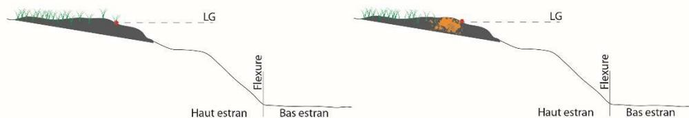
**Figure 50. Localisation du critère éco-géomorphologique (point rouge) servant à déterminer la limite géomorphologique (LG sur la figure) pour les côtes rocheuses sans falaise. À gauche de la figure, la LG se situe au front de la végétation herbacée éparses. À droite de la figure, la LG se situe au front du lichen (orangé).**
