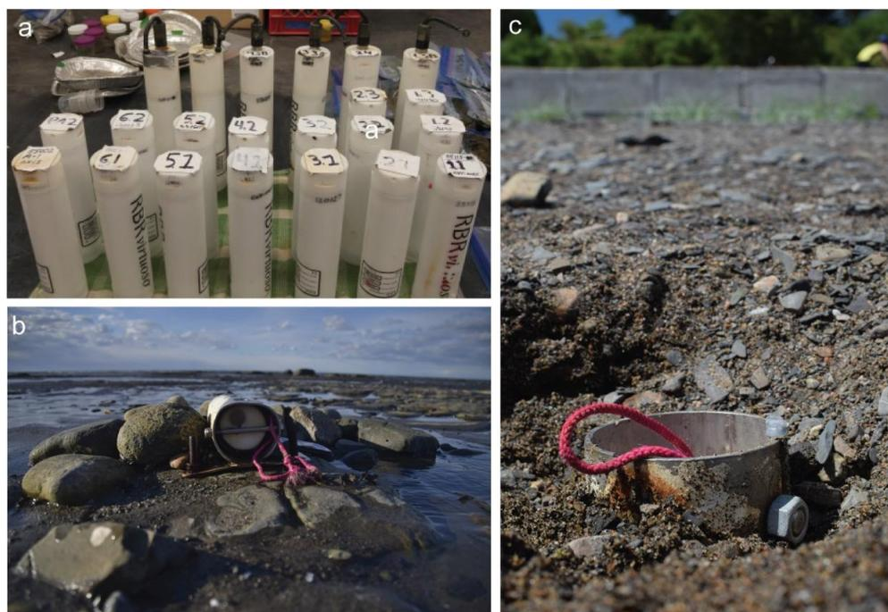
**Figure 69. Exemple de capteurs RBR nécessaires aux inventaires en zone intertidale (a) ; exemple d'installation sur roc (b) ; et en milieu sableux (c)**
