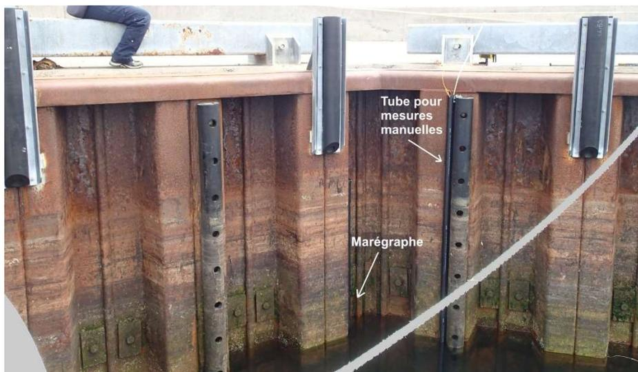
Figure 15 – Vue générale du marégraphe installé dans l'angle du quai et du tube temporaire utilisé pour les mesures manuelles.
