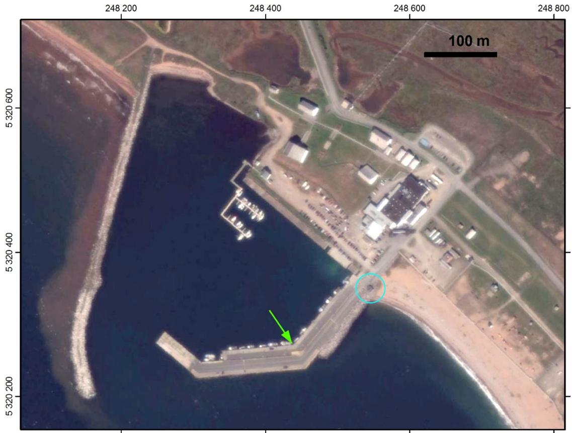
Figure 13 – Position du marégraphe (flèche verte) et du baromètre enregistreur (cercle bleu) dans le port de Paspébiac.
