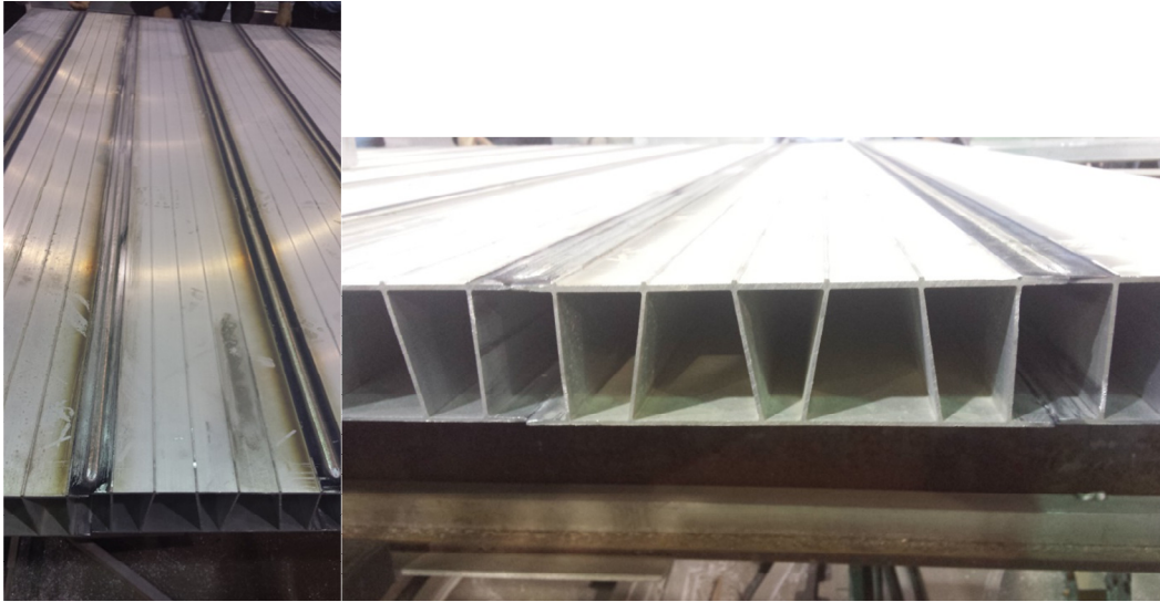
Figure A1.4 : Extrusions d'aluminium de la remorque Capacity soudage MIG
