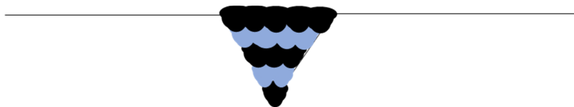
Figure 7.5 Soudure de 20 mm de profondeur avec 5 étages de passes et 15 passes
