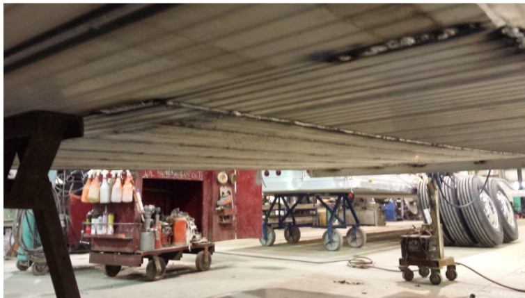
Figure A1.7 : Vue du soudage entre des extrusions transversales et longitudinales de hauteurs différentes
