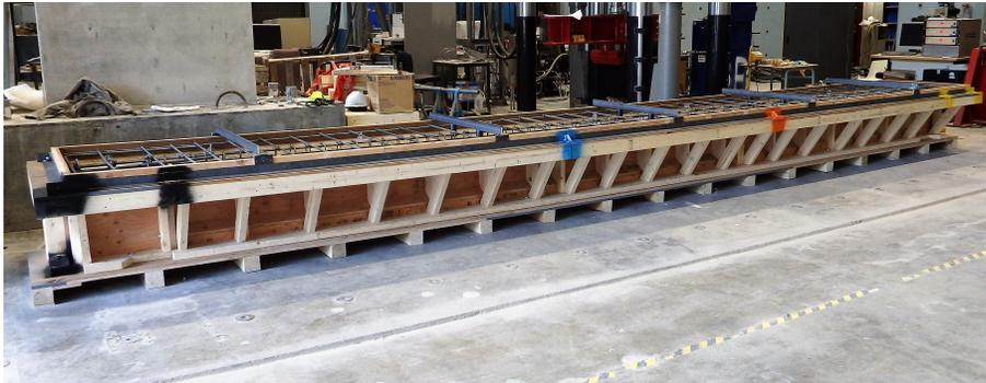
Figure 3.4 – Coffrage de la poutre
