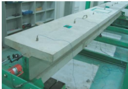
Figure 2.12 – Poutre précontrainte testée par Kim et al. [19]
