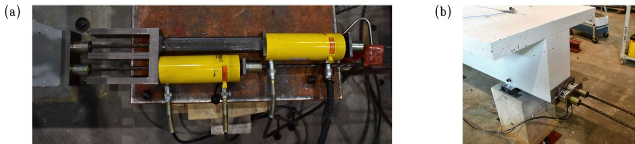
Figure 3.5 – Ancrage des torons : (a) Système de mise en tension et (b) ancrages et cellules de force
