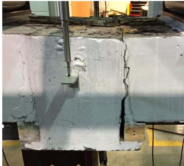
**Figure 4-19 :** Détérioration du spécimen avec barres interrompues suite au chargement cyclique
