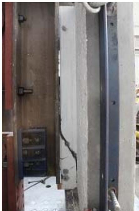
**Figure 3-31** – Mode de rupture du spécimen F8-G100-DU
