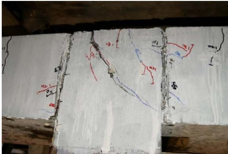
**Figure 4-10 :** Patron de fissuration du spécimen avec joint droit à la rupture
