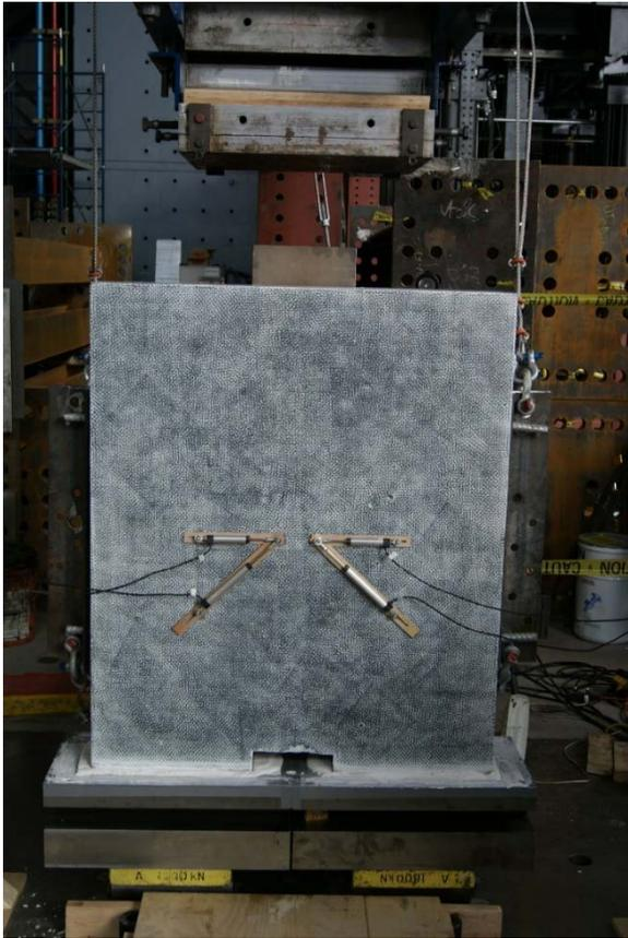
**Figure 3-15** – Montage I – Face Nord du spécimen O8-G0-Ax
