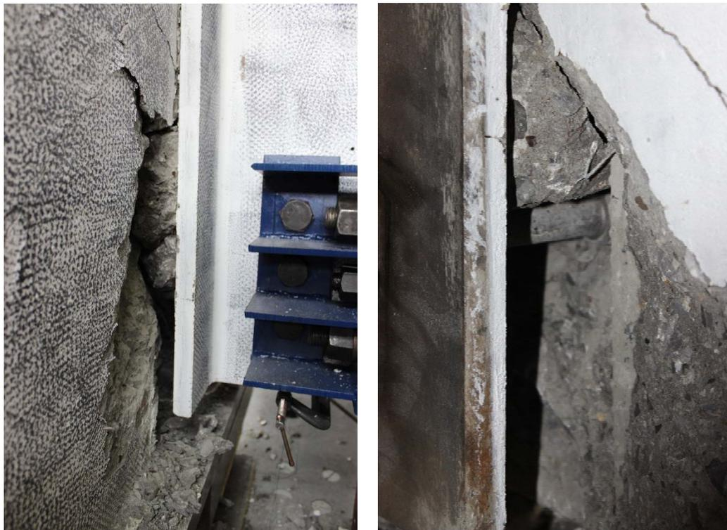
**Figure 3-28** – Détail du mode de rupture du spécimen O8-G0-Ax
