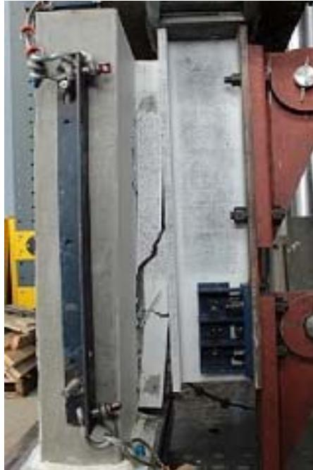
**Figure 3-29** – Mode de rupture du spécimen F16-G75-Cx
