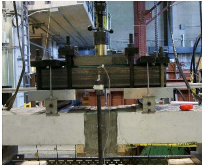
Figure 4-16 : Photo de l'application de la charge pour le moment positif
