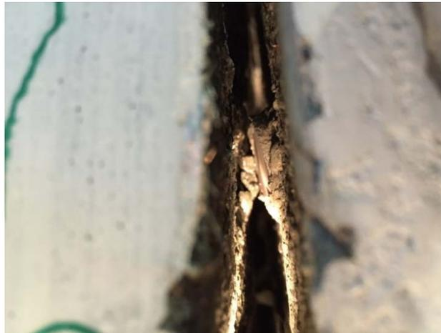
**Figure 4-20 :** Rupture de la barre d'armature interrompue
