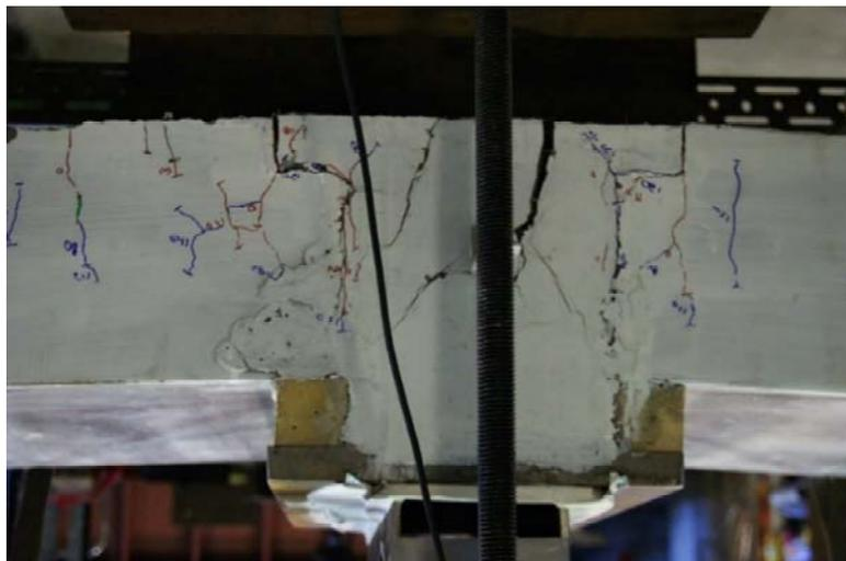
**Figure 4-11 :** Patron de fissuration du spécimen avec les petites ailes à la rupture
