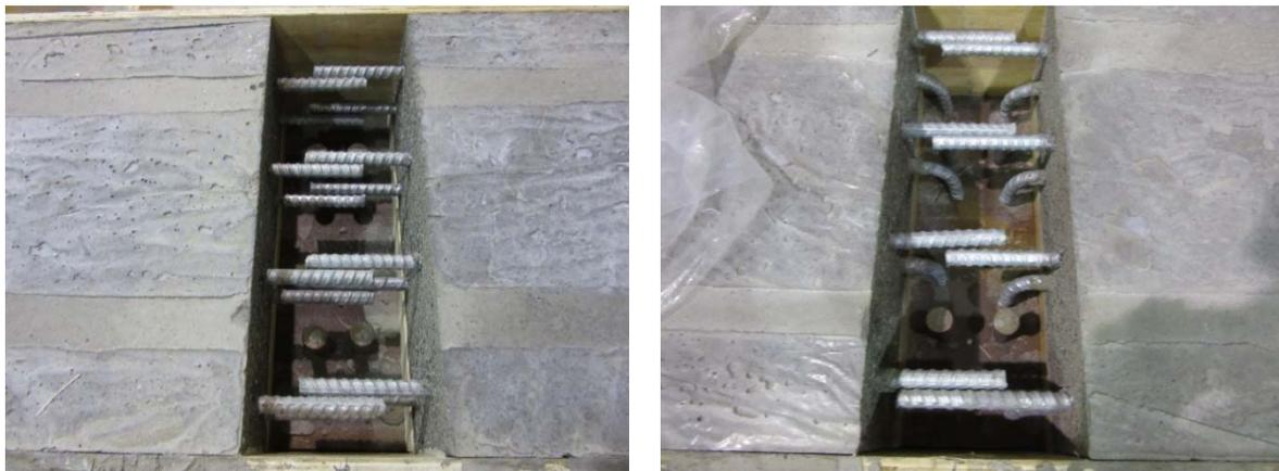
a) Barres inférieures chevauchées                      b) Barres inférieures interrompues
