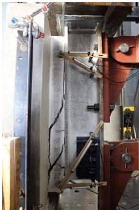
**Figure 3-30** – *Mode de rupture du spécimen F8-G100-D*
