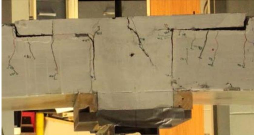
**Figure 4-12 :** Patron de fissuration du spécimen avec les grandes ailes à la rupture
