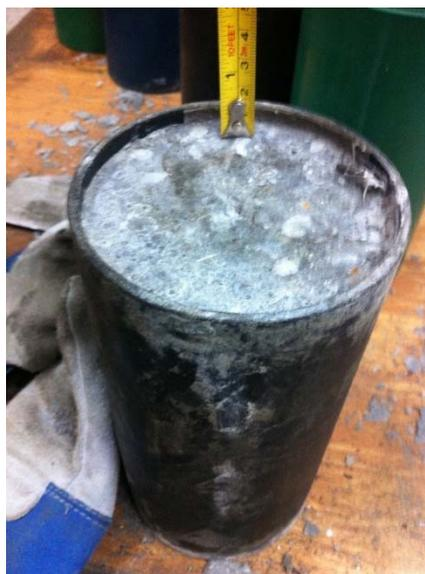
**Figure 2-7 : Retrait du BFUP mesuré sur un cylindre après 5 jours de mûrissement**
