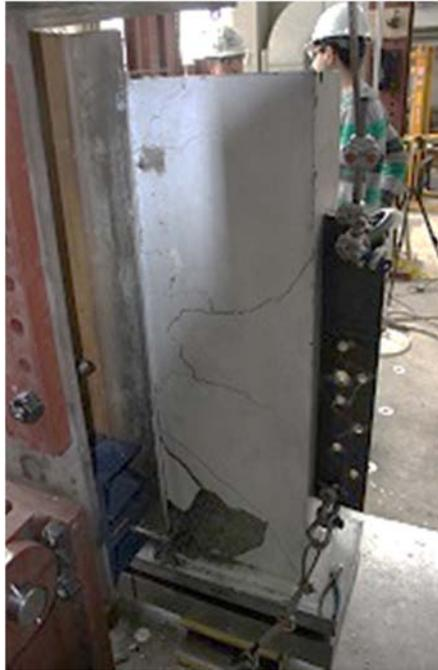
**Figure 3-27** – Mode de rupture du spécimen O8-G0-Ax (2015-03-30)
