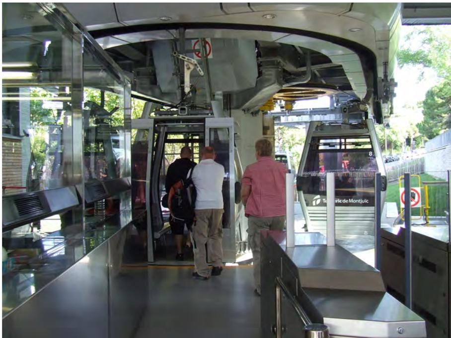
Techniquement, des systèmes ont été homologués en France et l'arrêt n'est pas indispensable suivant la largeur des portes et la capacité de la cabine. Or sur l'accessibilité pour les personnes à mobilité réduite (PMR), il est surtout fait état de la possibilité pour un usager en fauteuil roulant d'entrer dans la cabine en marche. Il est nécessaire de prendre en compte les enfants en bas âge et les personnes âgées manquant d'équilibre.
