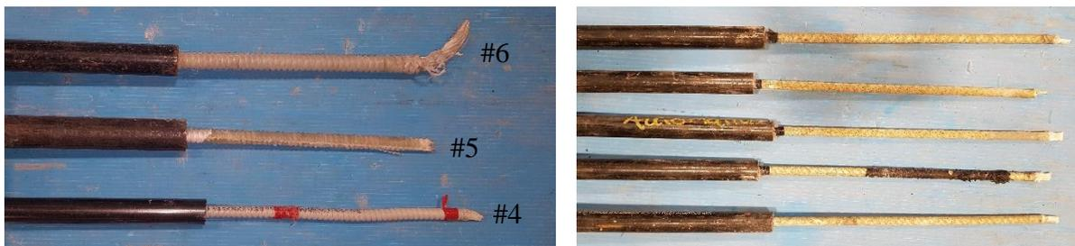
Figure 5-18 - Mode de rupture des barres #4 et #3
