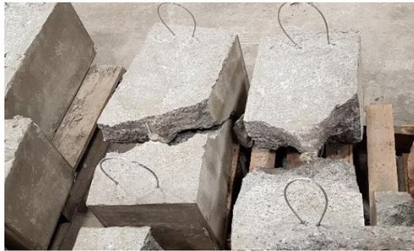
Figure 5-19 - Blocs de béton brisés suite à l'essai de barres #8
