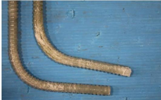
*Figure 5-9 - Fissures longitudinales dans la partie courbe des barres de type D*
