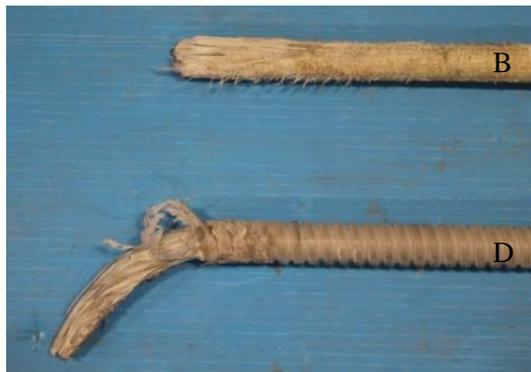
Figure 5-14 - Mode de rupture des barres #6 de types B et D, avec renforcement du bloc de béton
