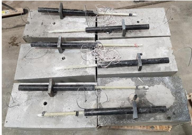
Figure 5-17- Rupture de barres coulé avec béton haute performance à prise rapide
