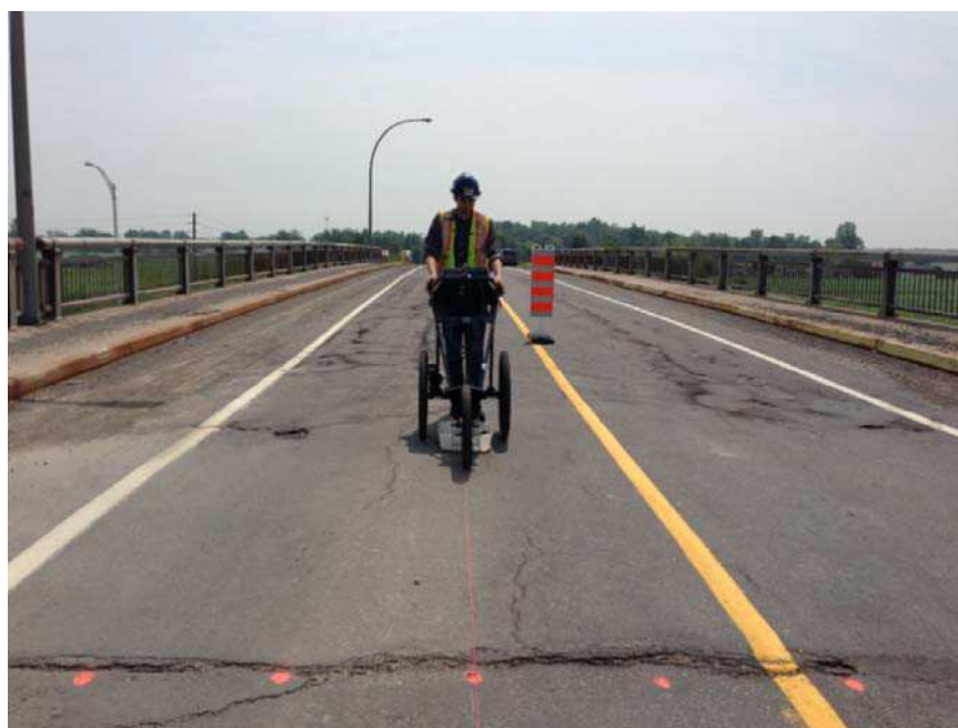
Figure 6.4 Balayage de la dalle du pont avec le géoradar
