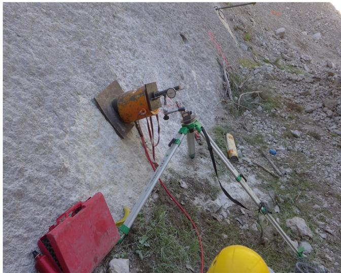
Figure 10 : Vue du dispositif de réalisation d'un essai de boulon. Vérin annulaire et trépied de mesure
