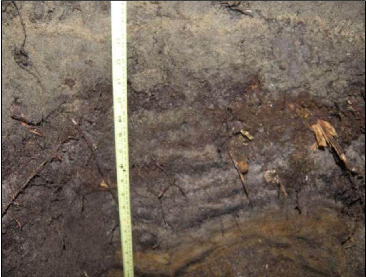
Figure 16 : Photographie de la stratigraphie du sondage test 1 (S1), montrant LFH, Ah, Ae, Bf et Bh. Projet 154-14-0968 (km 33), photo : 154140968\_161031\_006
