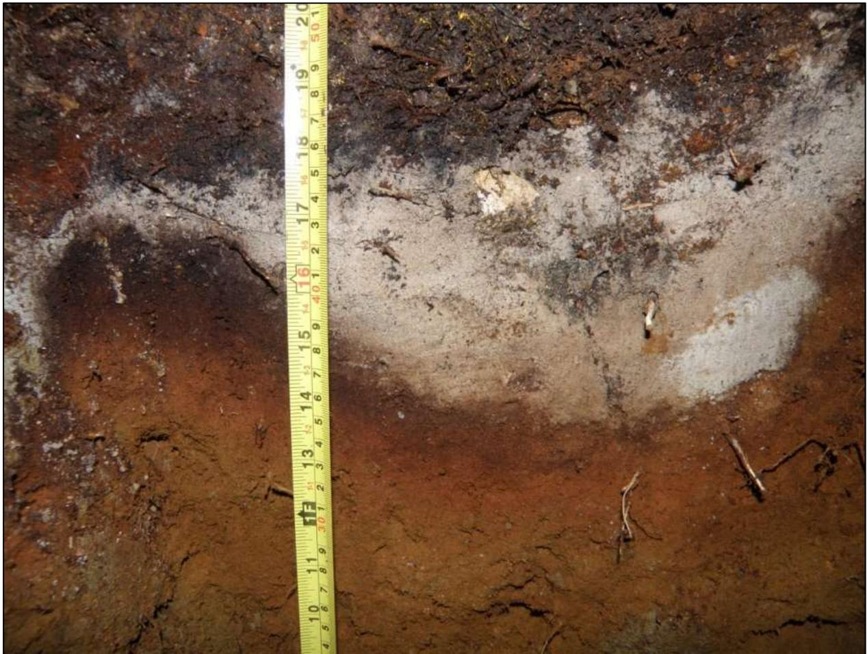
Figure 25 : Photographie de la stratigraphie du sondage test 1 (S1), montrant LFH, Ah, Ae, Bf et Bh. Projet 154-14-0963 (km 157), photo : 154140963\_160525\_007
