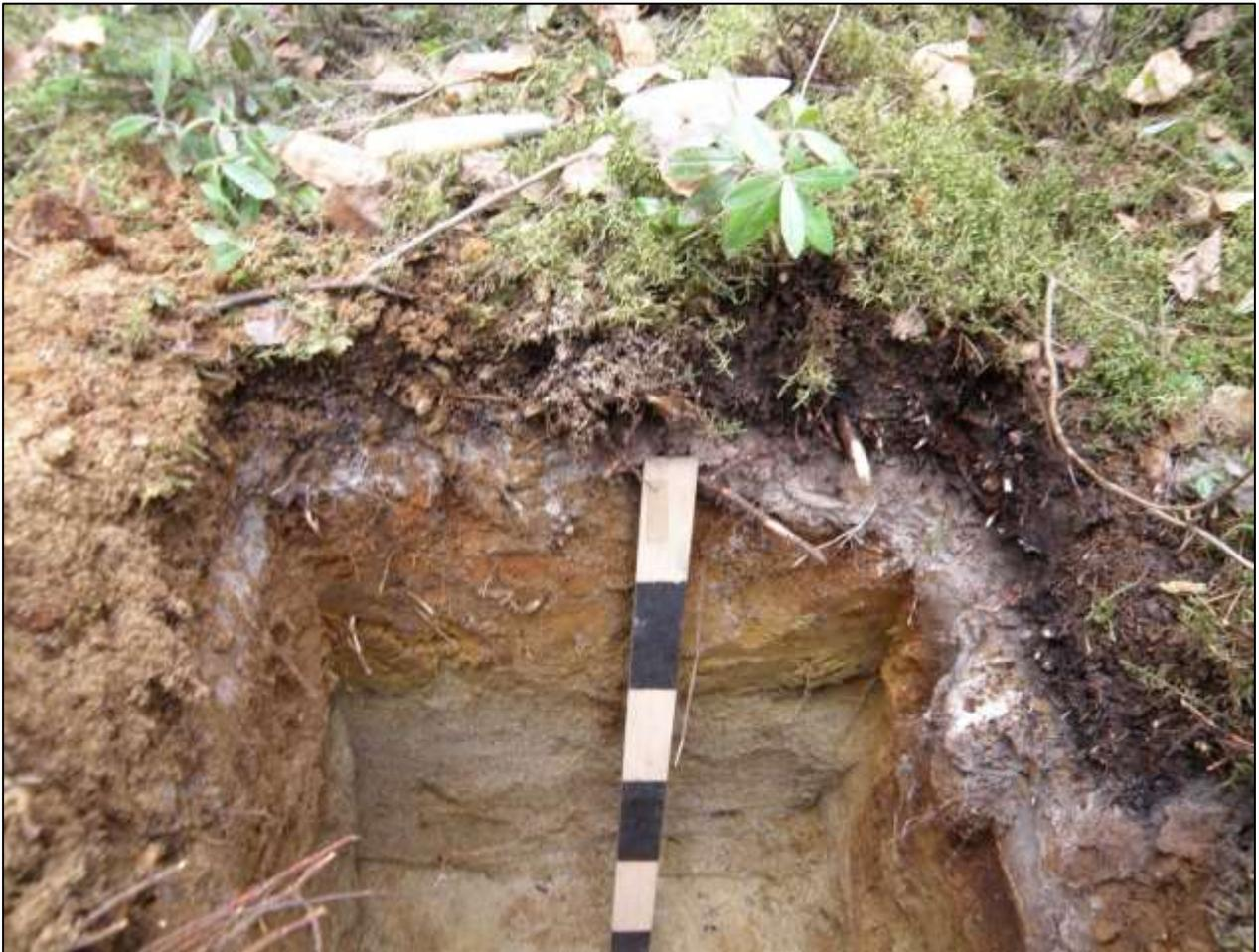
Figure 10 : Photographie de la stratigraphie du sondage test 1 (S4), montrant LFH, Ah, Ae, Bf et Bh. Projet 154-14-0961 (km 26), photo : 154140961\_160525\_006
