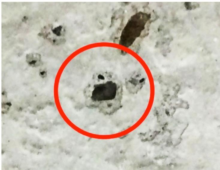
Figure III-18 Cône de pâte détachée et fracture visible à la surface du granulat
