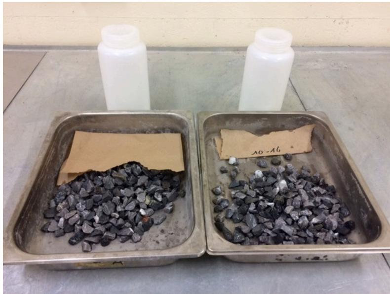
Figure III-14 Échantillons gel-dégel non confiné
