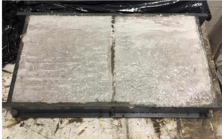
Figure III-26 Plaque d'écaillage une fois l'agent de mûrissement appliqué
