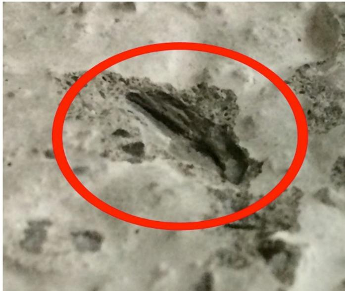
Figure III-17 Fracture visible dans le granulat
