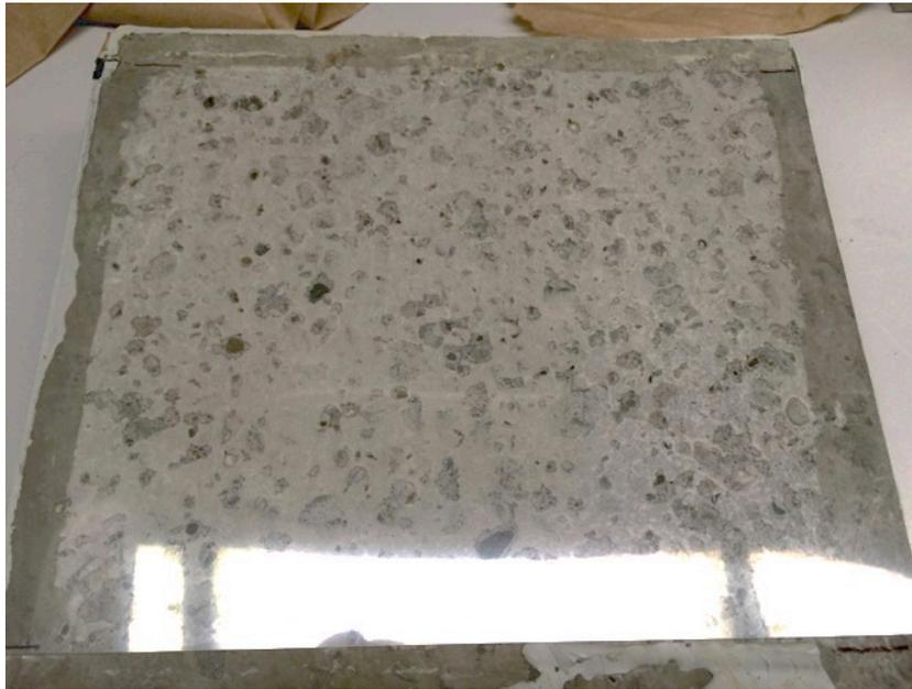
Figure III-20 Acétate appliquée sur la surface de la plaque à analyser
