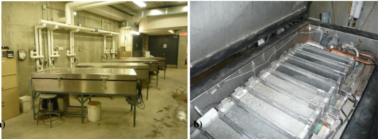
Figure II-13 Coffres réfrigérés utilisés dans le laboratoire de l'Université de Sherbrooke : vue de l'extérieur a) et vue intérieure b)
