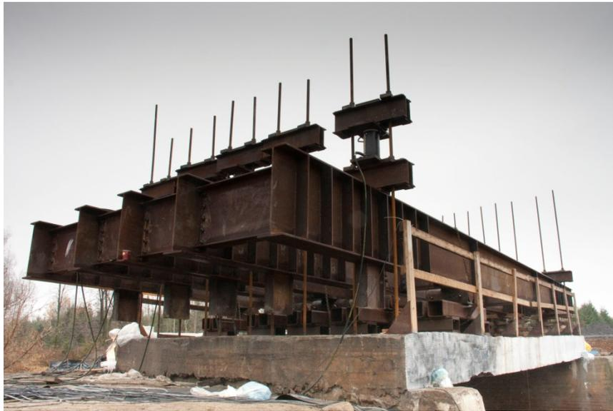
**Figure 4.10 – Banc d'essai**
