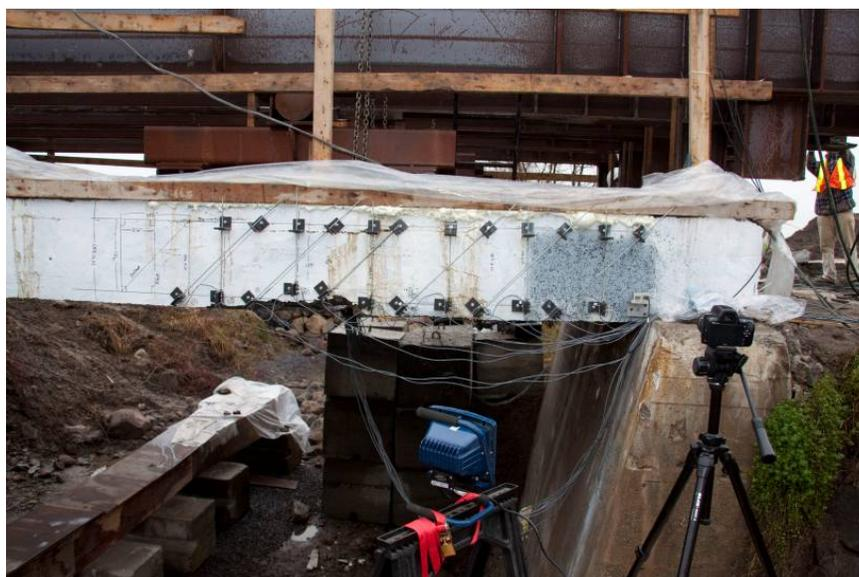
Figure 4.23 - Fixation des capteurs LVDT sur le côté de la dalle de béton
