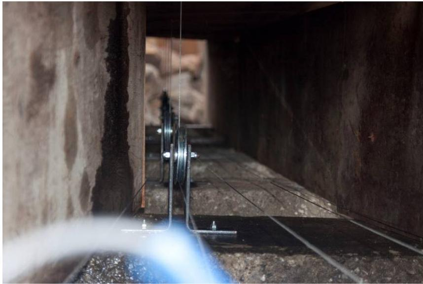
**Figure 4.27 - Système de poulies pour potentiomètres à corde**
