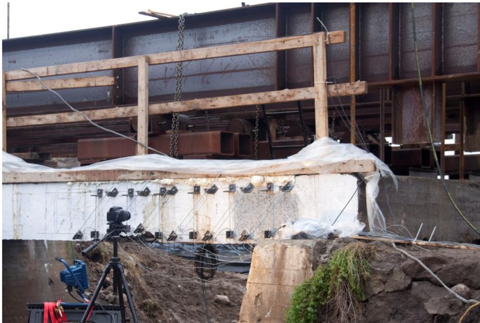
**Figure 4.35 – Application de l'imagerie numérique (appareil photo)**
