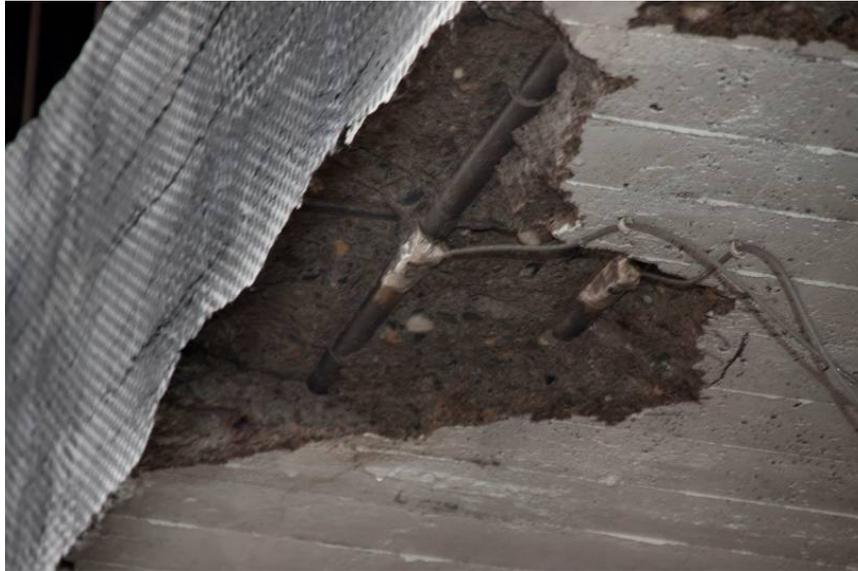
**Figure 4.24 – Installation des jauges de déformation sur les barres d'armature de flexion**
