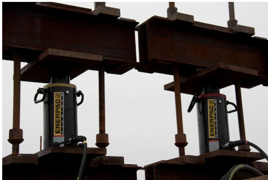
**Figure 4.13 - Système de chargement**
