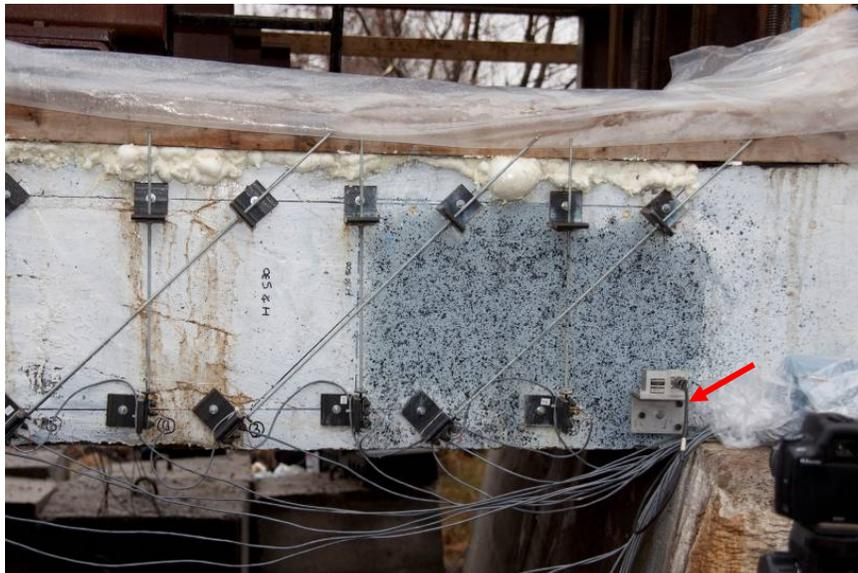
**Figure 4.28 – Installation des inclinomètres (capteur de rotation)**
