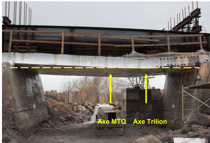
Figure 5.28 – Comparaison des points de mesure des flèches
