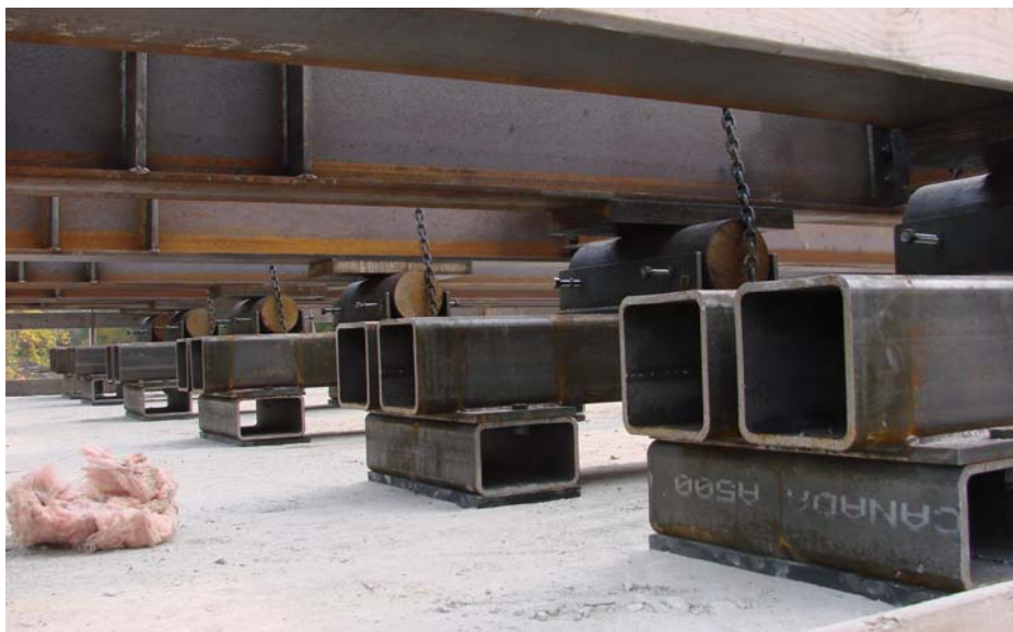
Figure 4.13 – Vue d'ensemble des six chariots de chargement
