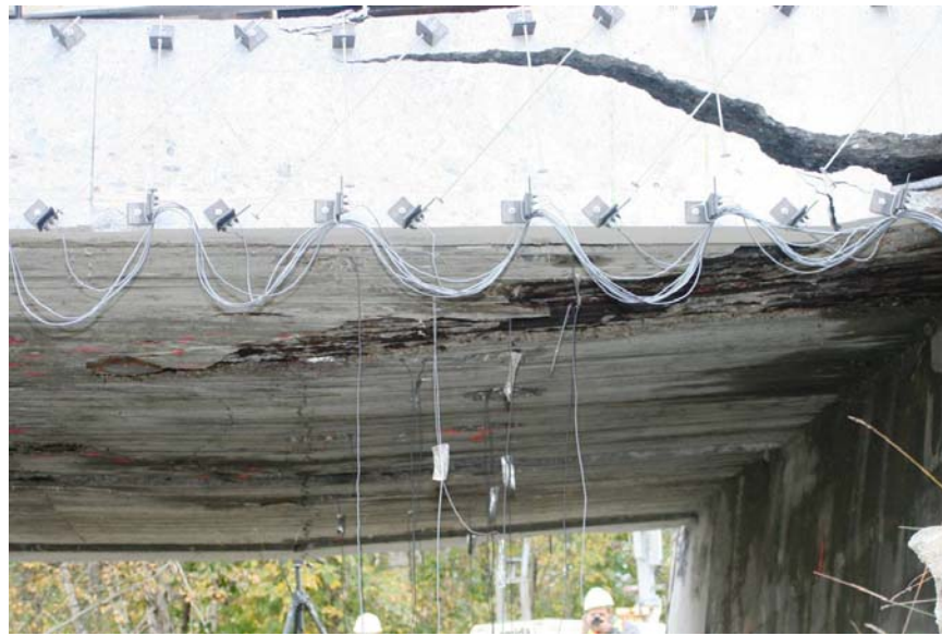
Figure 5.16 – Rupture en cisaillement du côté Nord-Est
