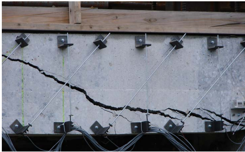
Figure 5.29 – Fissure en cisaillement – 3 de 4 (Charge maximale: V \approx 450 \text{ kN/m} )
