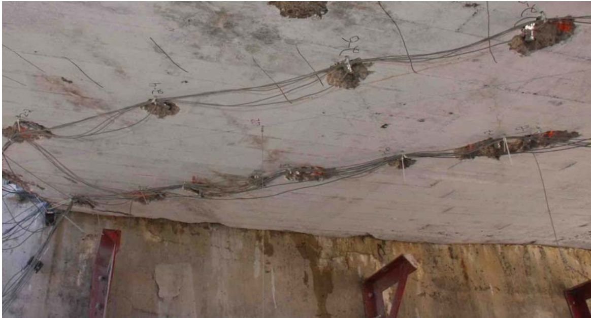
Figure 4.20 - Disposition des potentiomètres à corde sur site
