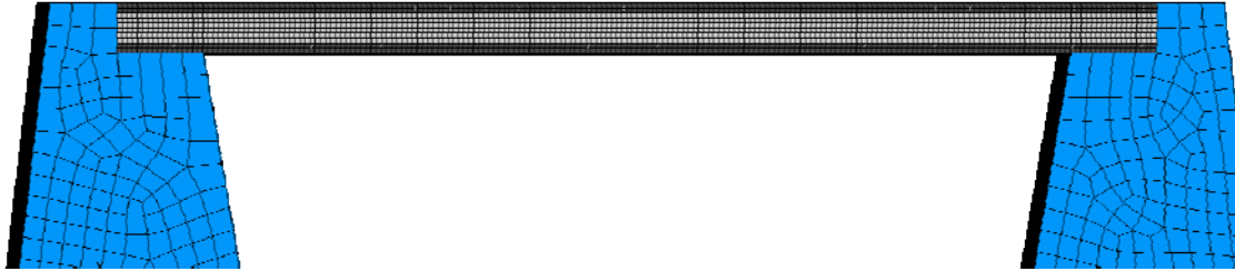
Figure 6.5 – Différentes propriétés du béton de la dalle et la culée
