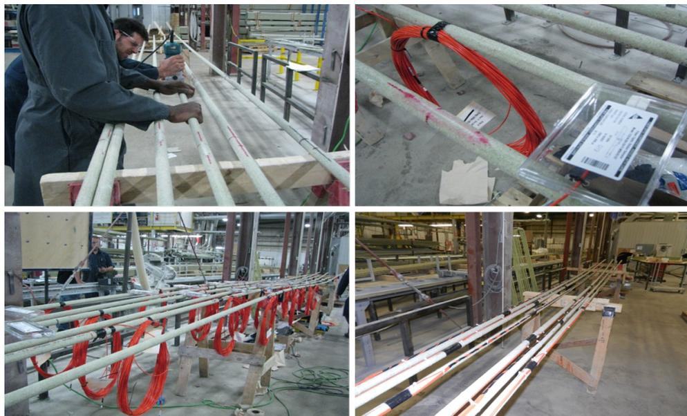
Figure 3.1 – Instrumentation des barres d'armature en PRFV
