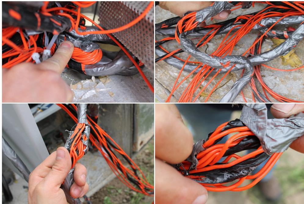
Figure 3.14 – Endommagement des capteurs à fibres optiques
