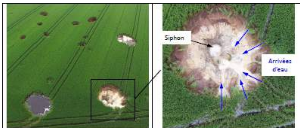
Figure n°6 – Effondrements à Gidy- extrait d'une vidéo réalisée lors du survol par drone - source BRGM
