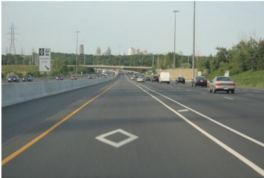
Figure 3. Voie réservée séparée par une zone tampon marquée
