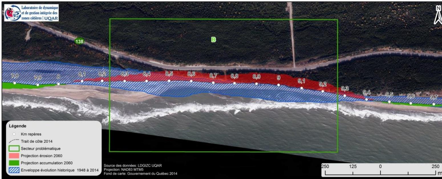
Figure 174. Projection de la ligne de rivage pour le secteur problématique B
