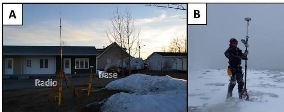
Figure 254. GPS-différentiel utilisé lors du projet à Longue-Pointe-de-Mingan. A. Radio (Trimble HPB 430-450 MHz) et récepteur de base (récepteur R8); B. Récepteur mobile monté sur une roue
