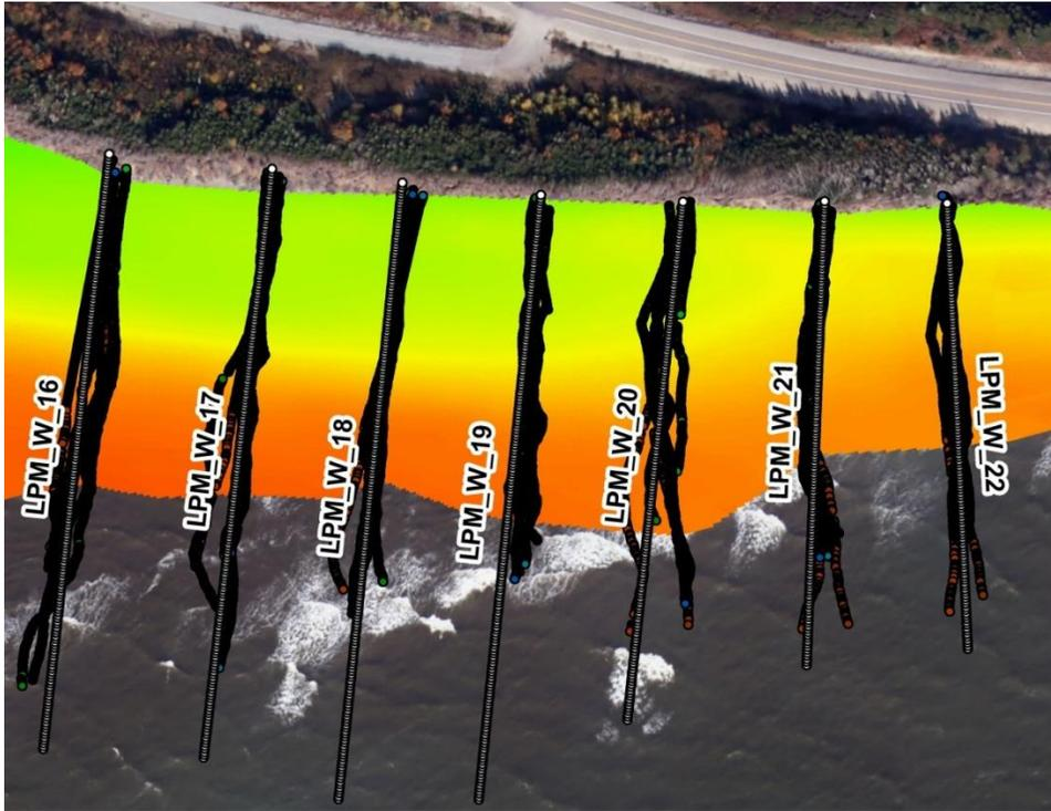
Figure 22. Illustration des profils DGPS sur une surface interpolée et positionnement de transects fixes permettant l'analyse de l'évolution topographique
