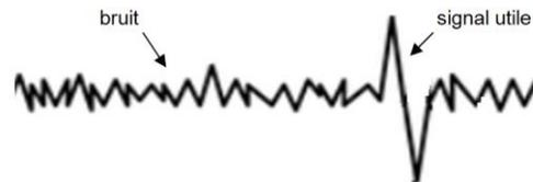
Le rapport entre l'amplitude du signal collecté et l'amplitude du bruit permet de mesurer la qualité d'un canal de transmission. Ce nombre est d'autant plus grand que le bruit est négligeable.
