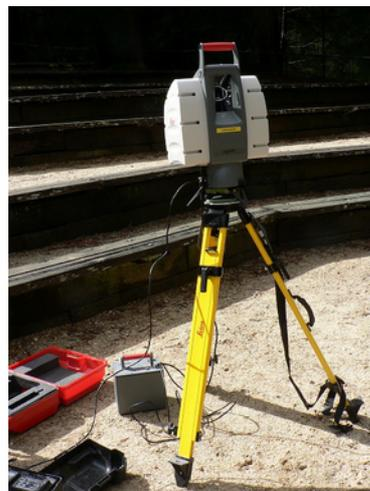
Lidar terrestre de marque Leica
