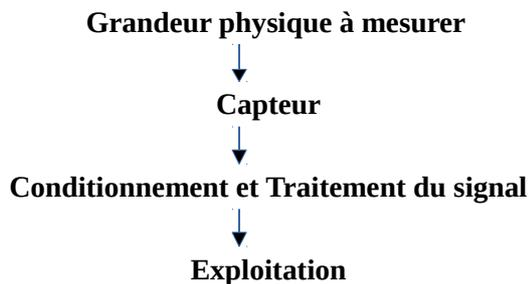
La partie de conditionnement et de traitement du signal est particulièrement importante en télédétection, puisque la grandeur physique mesurée (onde) est de nature très différente de la grandeur physique recherchée (distance ou déplacement).
