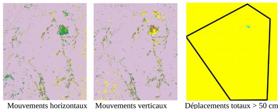
**Corrélation d'images terrestres sur le site du versant instable de Séchilienne (38) ayant permis de détecter la zone de départ d'un éboulement (16-20 juillet 2011)**
