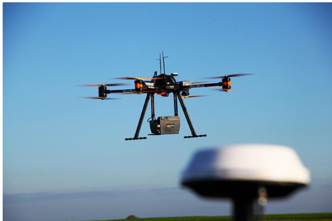
Lidar Yellowscan porté par un drone OnyxStar
