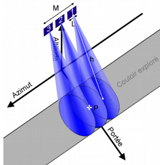
**Principe de fonctionnement du RSO : le point P est éclairé par une antenne équivalente de longueur M. La direction définie par le point éclairé au sol et le satellite (distance h) est appelée LOS (line of sight)**
