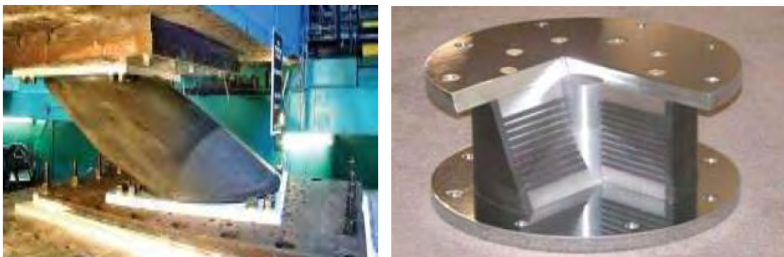
Figure 2 : Isolateur en élastomère fretté avec noyau de plomb
