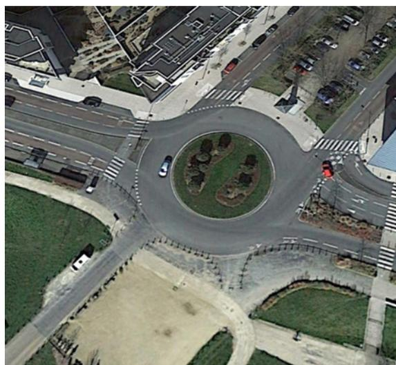
Les voies réservées aux bus sont ici latérales. La taille du giratoire est supérieure à 25 m. On perçoit sur la photo que le bus en entrée est en position avancée par rapport aux véhicules situés à sa gauche.
