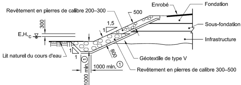
**Figure 2 Plan en coupe d'un enrochement typique.**
