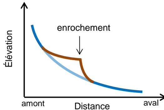
**Figure 5** Bris de pente créé par l'enrochement
