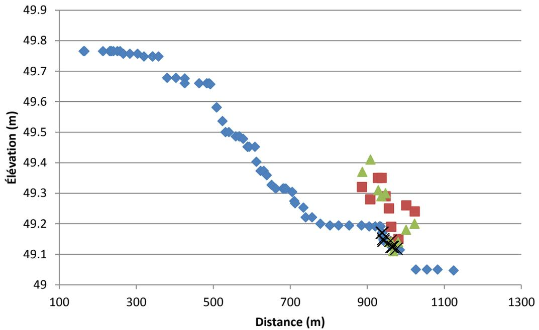
Profils longitudinaux de la surface de l'eau relevée au DGPS pour les cours
