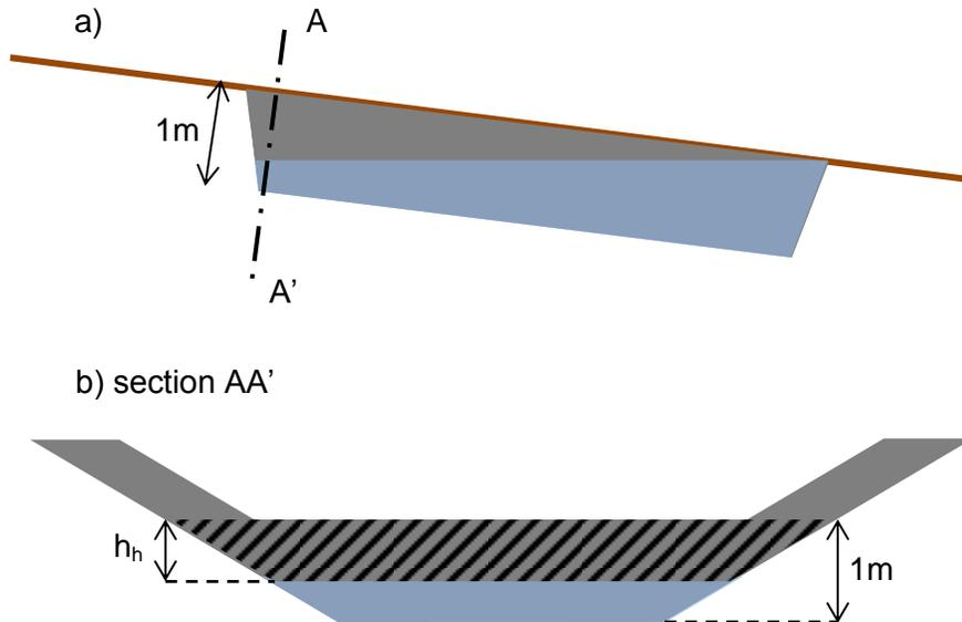
**Figure 18 Schéma des écoulements hyporhéiques dans un enrochement**
