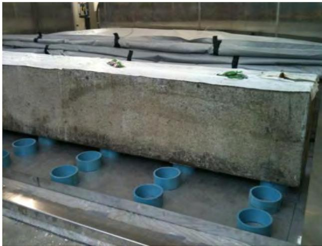
**Figure 60 : Cylindre en PVC (Calibre DR-18) pour le support des dalles.**
