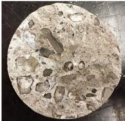
Figure 14 : Plan de rupture en tension d'un échantillon de béton atteint de RAS.
