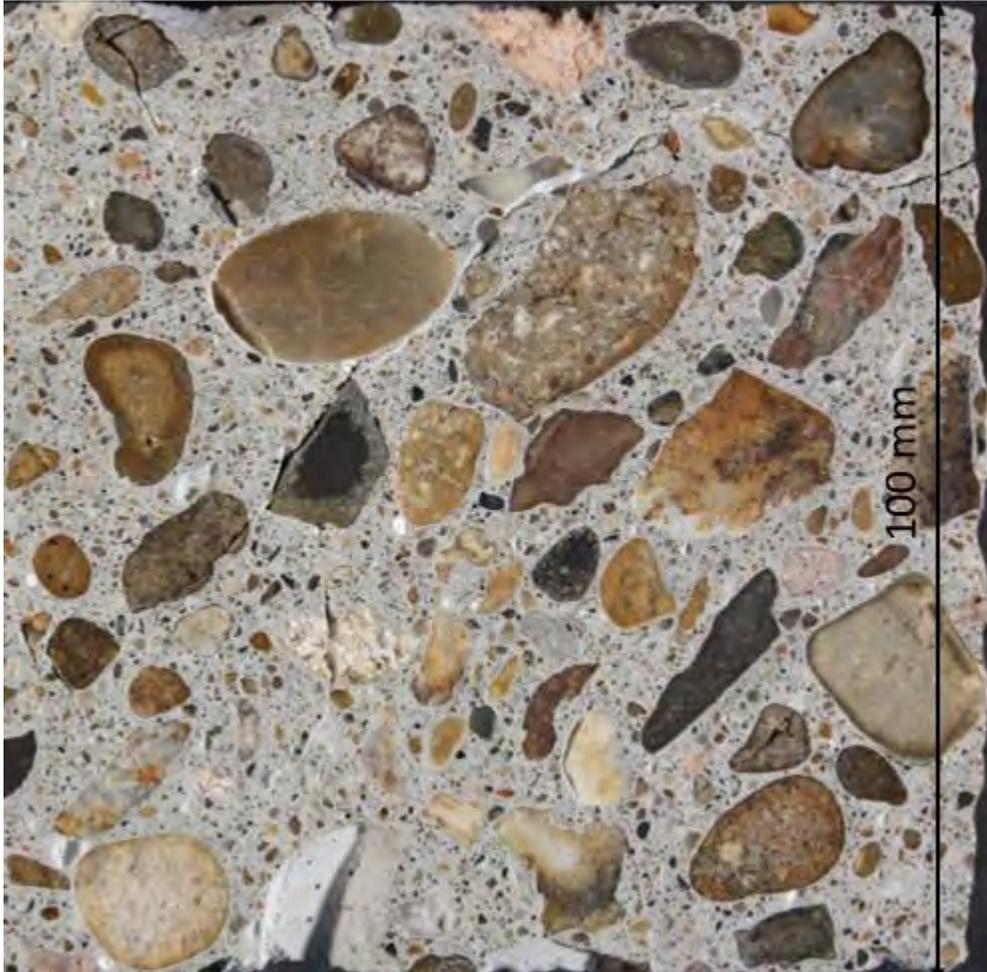
**Figure 115 : Exemple du réseau de fissuration visible à l'œil nu
