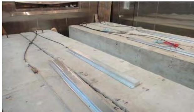
**Figure 52 : Capteurs à fibre optique sur le dessus des dalles.**
