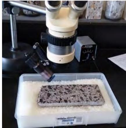
**Figure 28 : Stéréobinoculaire utilisé pour l'identification des indices de détérioration.**
