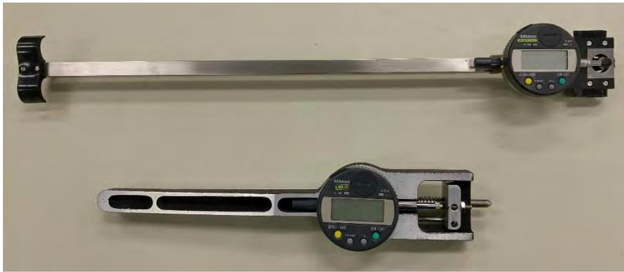
Figure 48 : Extensomètres de 500 et 250 mm.
