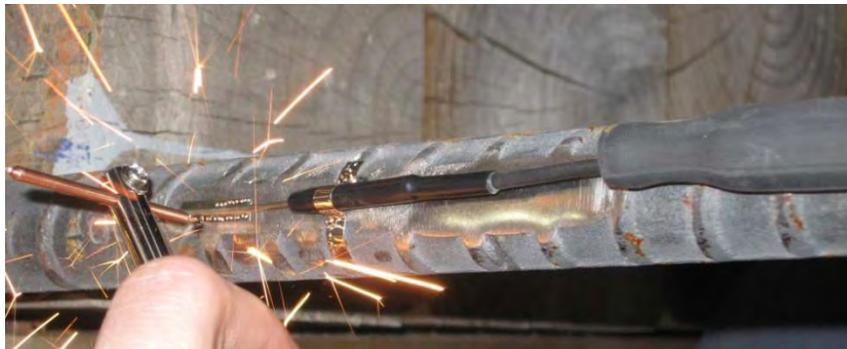
Figure 51 : Installation d'une jauge soudée.
