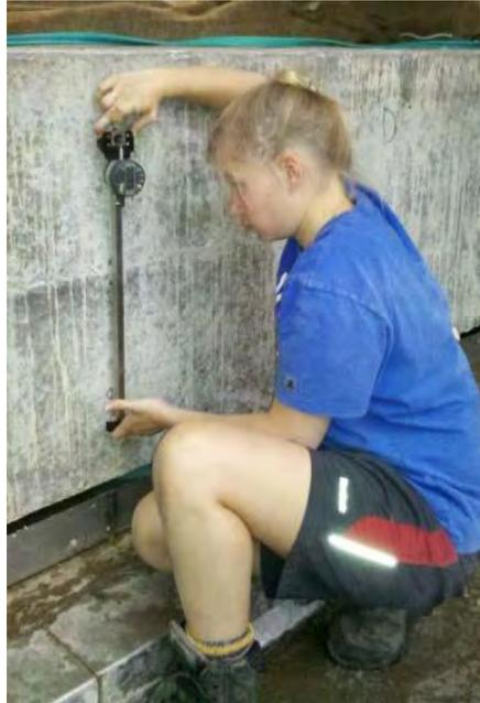
Figure 62 : Prise de mesure de changements dimensionnels
