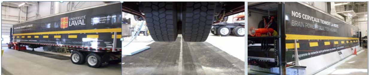
Figure 2-4 : Simulateur de charges lourdes de l'Université Laval
